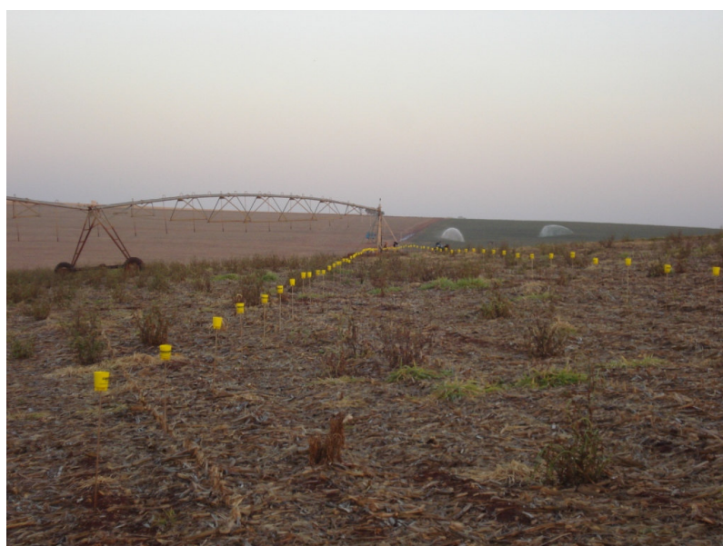
Figura 13. Disposição dos coletores de água na posição em nível.
