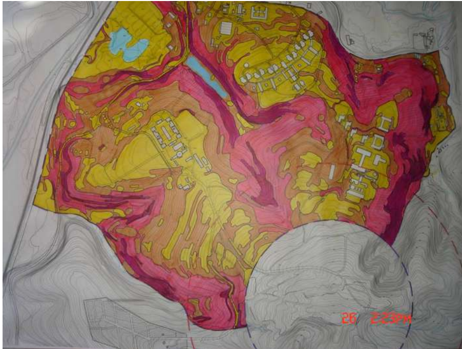
Ilustração 236 - Outro nível de detalhamento, foi sugerido a indicação dos grupos de declives do terreno, indicando com cores as mudanças significativas – amarelo plano até 30%, marrom de 30% a 45%, vinho de 45% a 50% e lilás mais de 50%
