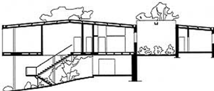
Fig. 16. Corte transversal da Casa de Vidro.
