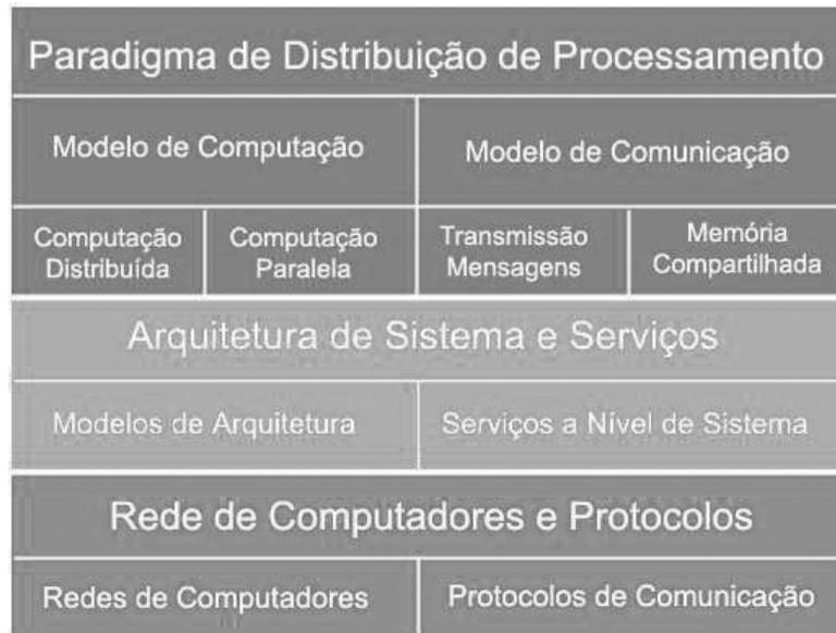
Figura 2.4. Arquitetura de Software de Sistemas de Distribuição de Processamento
