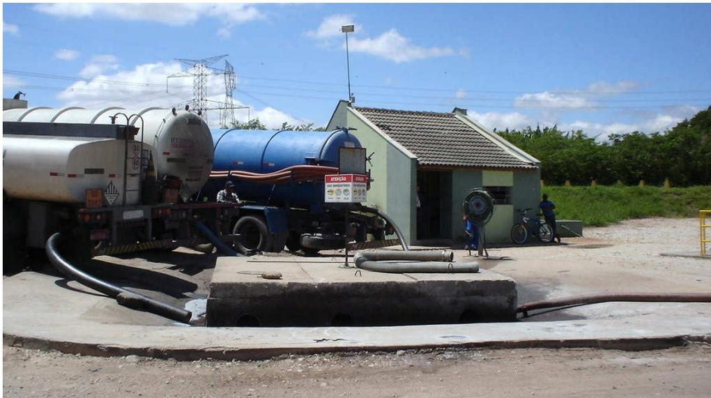
Figura 5: Despejo de efluentes por caminhões na ETEJ.
