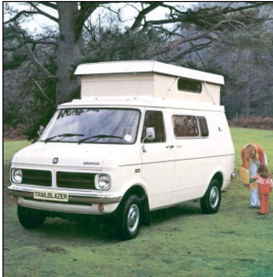
Figura 87 - Trailblazer do Ci de 1976 em uma Bedford CF220 com novo projeto elevating do telhado. - Fonte: Andrew Jenkinson - Motorhomes - The Illustrated History – p.46
