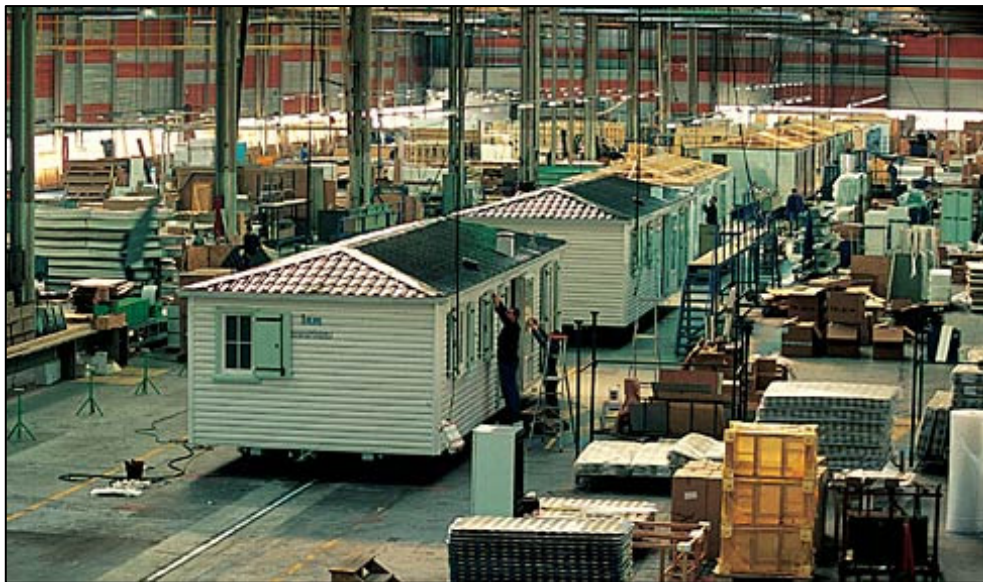
Figura 99 – Produção em linha de montagem – pela empresa fancesa “IRM, Holiday Homes ”. Fonte: http://www.irm-holidayhomes.com/technical.php
