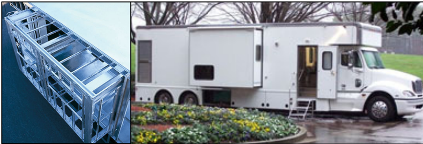
Figura 88 – Detalhe da estrutura em alumínio e sistema expansível Fonte: http://www.optimatrailers.com/motorhomes/gallery1.php
