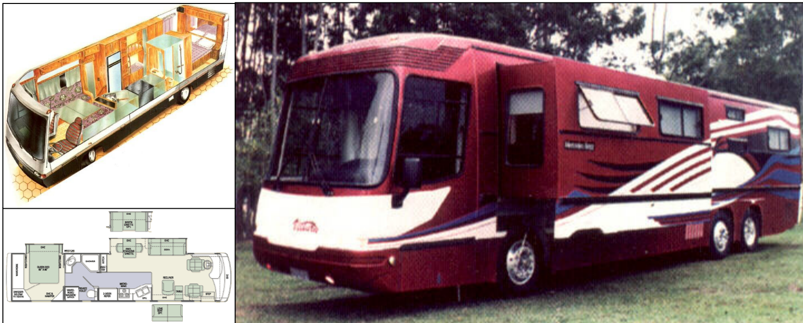
Figura 89 – Modelo tem paredes móveis possibilitando a expansão da área interna quando este se encontrar estacionado Fonte: http://www.macamp.com.br/rvs.htm .
