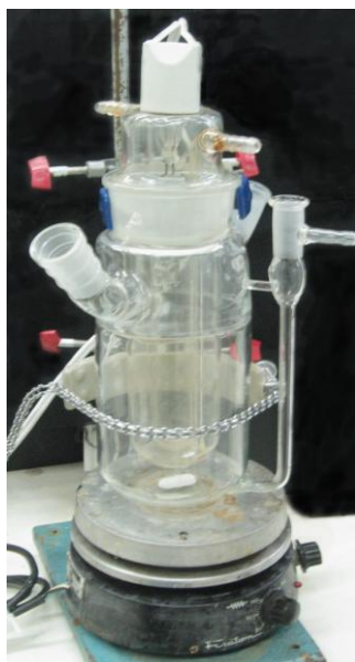
Figura 6 Reator de UV/ H 2 O 2 montado no suporte universal juntamente com agitador magnético.
