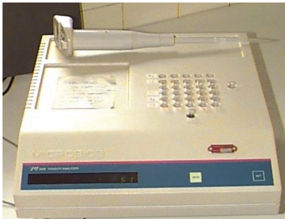
Figura 12 Analisador de Toxicidade por fotoluminescência bacteriana - Modelo M 500 Microbics.
