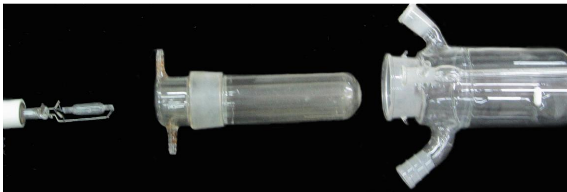
Figura 7 Partes que constituem o reator de cima para baixo são: bulbo da lâmpada de mercúrio, sistema de refrigeração com água corrente e recipiente de amostra.
