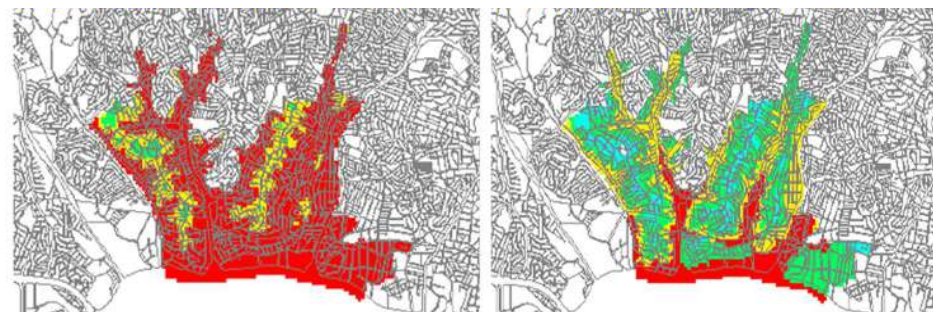
Fig. 37 - Em vermelho, faixas de pressão na rede acima de 50 mca. À esquerda, gradação das pressões sem VRPs na Freguesia do Ó, e à direita, com VRPs. Fonte: SABESP-FERNANDES (2006).
