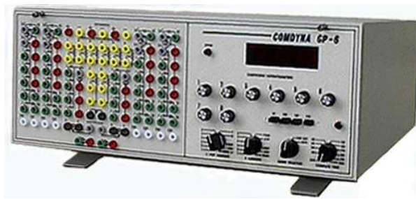
Figura 5.19 – Computador analógico GP-6 da Comdyna.
