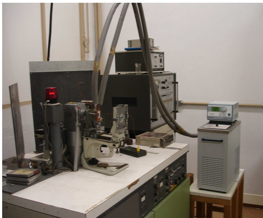
Fig. 3.12: Experimento de raios X com controle de temperatura.
