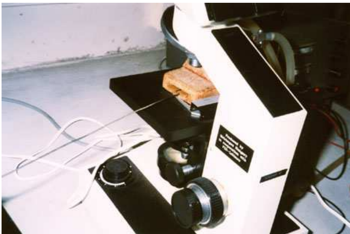
Fig. 3.6: Detalhe do sistema de aquecimento e refrigeração desenvolvido para análise no capilar.
