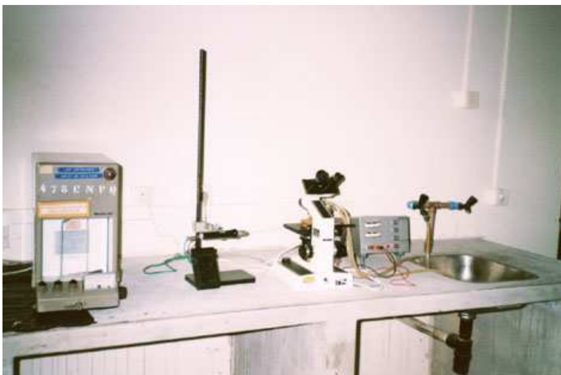
Fig. 3.5: Sistema montado para o estudo das amostras em capilares, por microscopia óptica.
