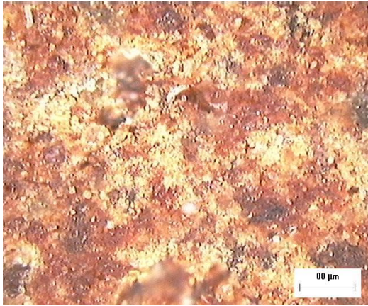
Figura 5.21 – Amostra contendo 20 % de cinza e submetida a 850 °C. Aumento de 100x
