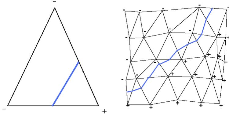
Figura 2.11: Exemplo do método de Hertzman para calcular a silhueta.
