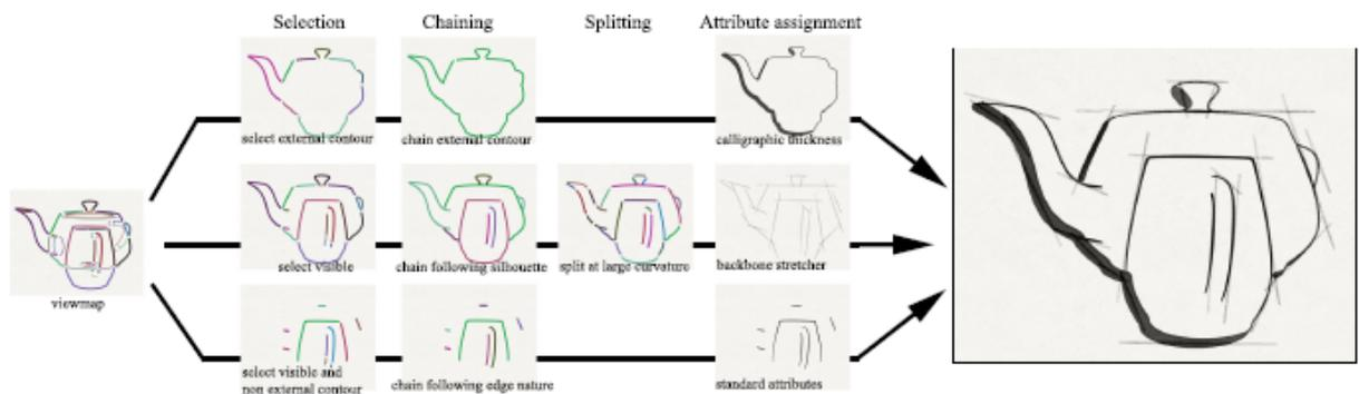
Figura 4.6: Exemplo dos operadores propostos por Grabli onde são usados dentro dos três módulos de estilo constituindo um estilo sheet simples.
