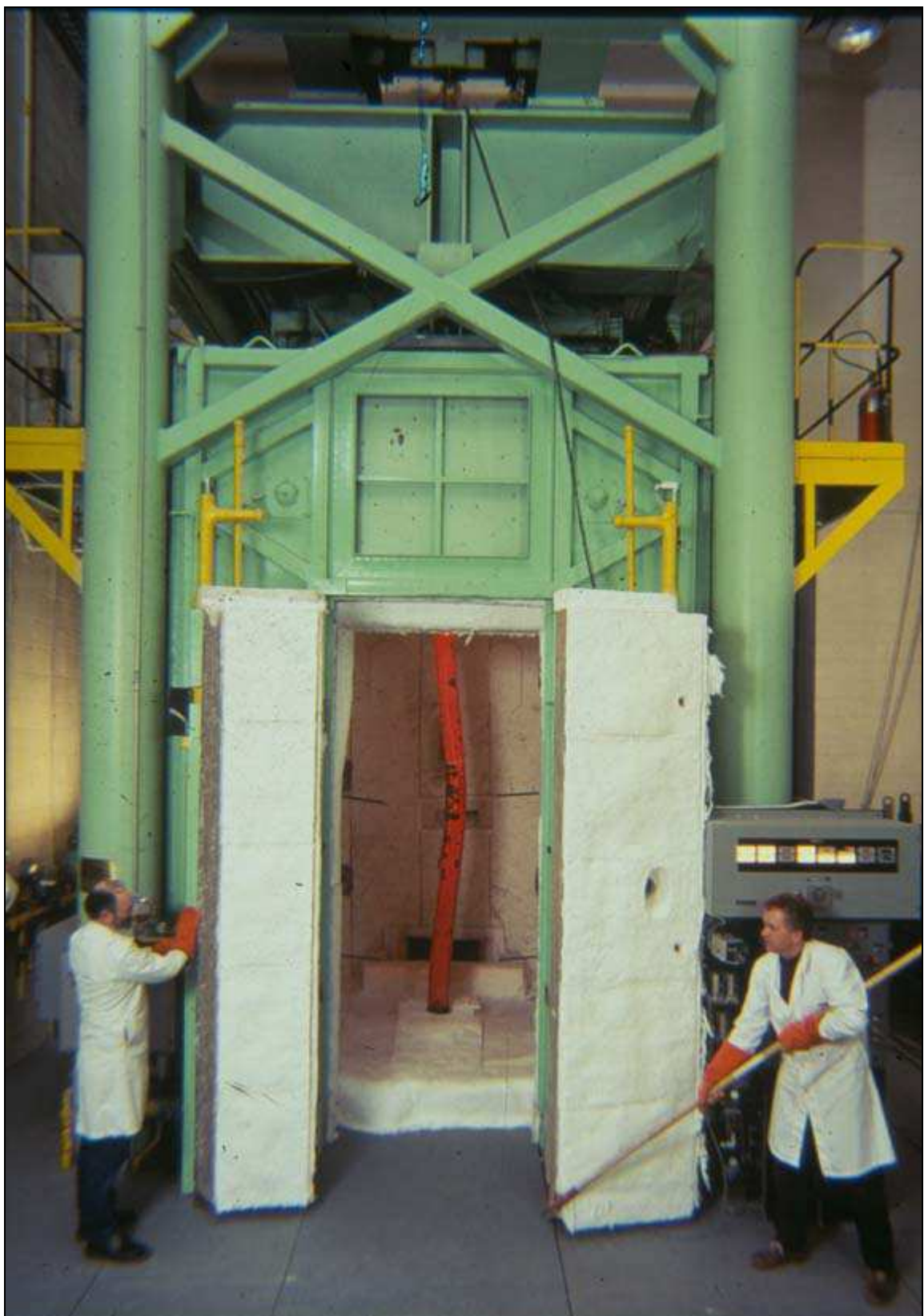
Figura 41 – Forno a gás utilizado e coluna após o ensaio – KODUR (2004)
