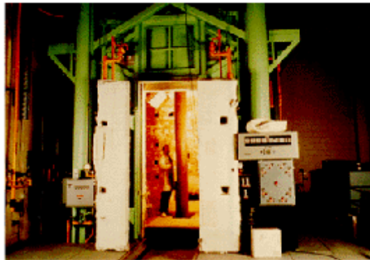
Figura 30 – Forno onde foram ensaiados os pilares – LIE e CHABOT (1998)
