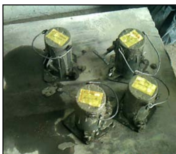
Figura 44 – Corpos-de-prova de concreto na mesa vibratória
