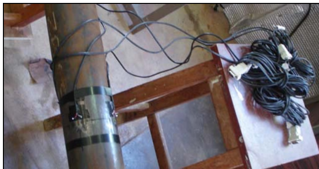
Figura 48 – Solda entre os fios do aquisitor e os extensômetros
