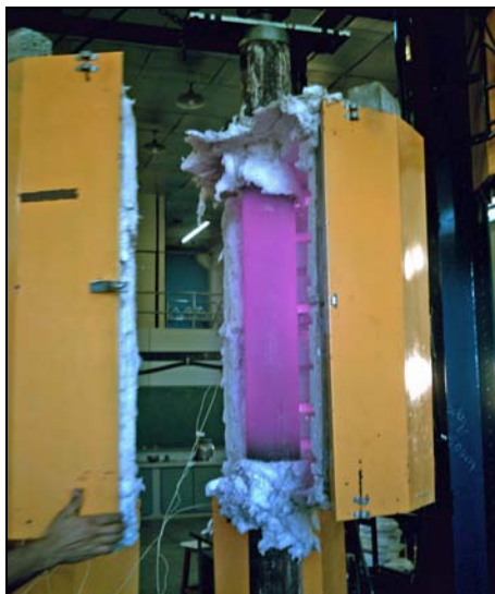
Figura 96 – Aspecto luminoso da coluna T168-C75-30-2 após o encerramento do ensaio
