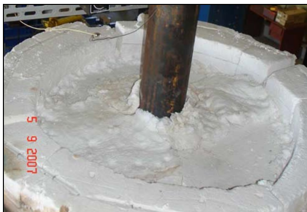
Figura 55 – Isolamento da parte superior do forno
