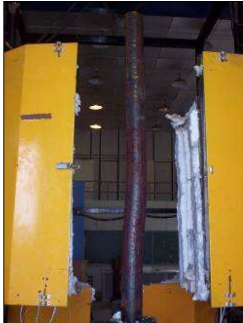
Figura 77 – Coluna T114-C00-70-2 após o ensaio
