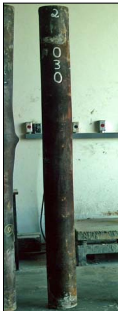
Figura 100 – Situação da coluna T168-C75-30-2 após o encerramento do ensaio
