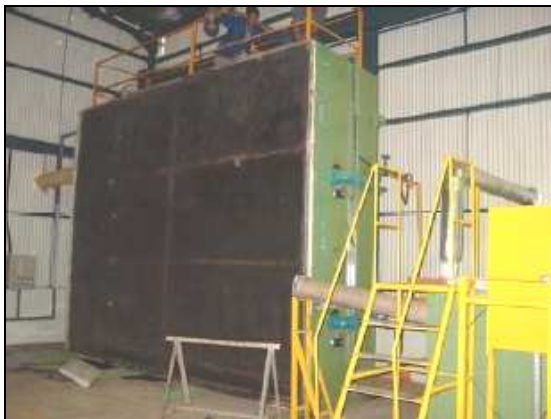
Figura 25 – Forno para ensaios a altas temperaturas em Furnas – SILVA (2006b)
