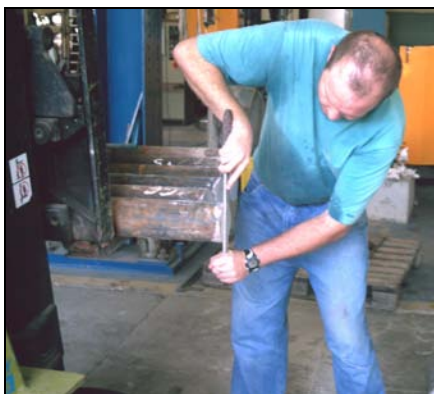
(a) regularização de uma extremidade
