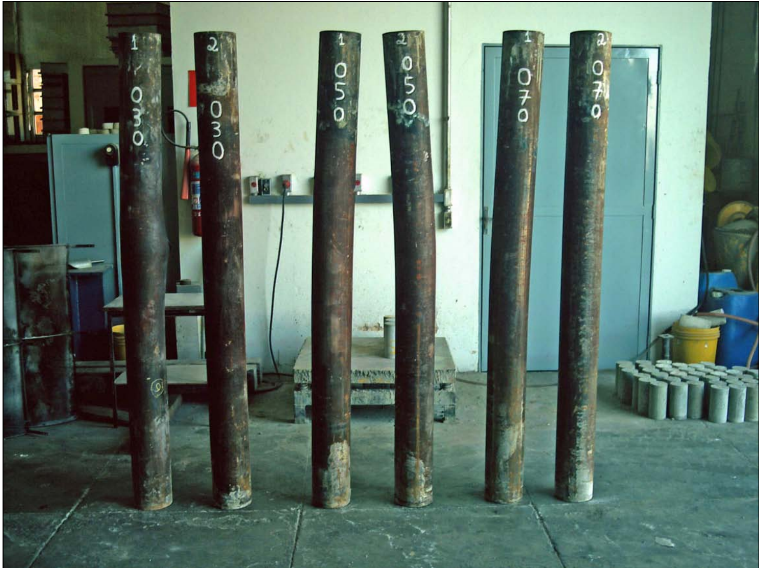
Figura 107 – Colunas de diâmetro 168,3 mm após os ensaios
