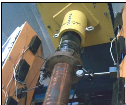
Figura 63 – Transdutores de deslocamento no topo das colunas
