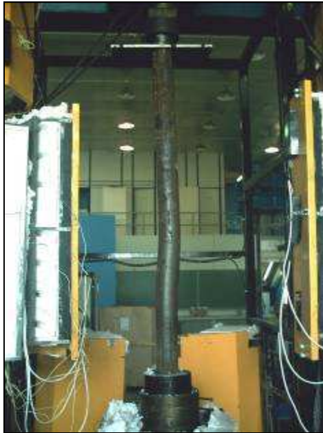
Figura 75 – Coluna T114-C00-50-2 após o ensaio
