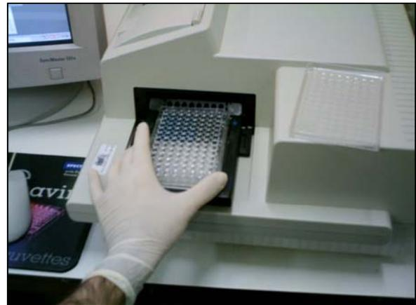
**Figuras 18 e 19.** Determinação de proteínas totais por espectrometria através da técnica de Bradford.
