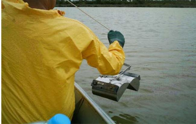
**Figura 13.** Coleta de sedimento através da draga de Pettersen.
