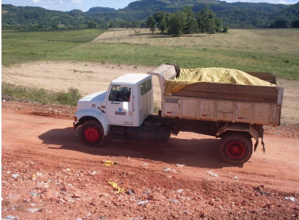
Figura 3.4– Caçamba para transportar rejeito
