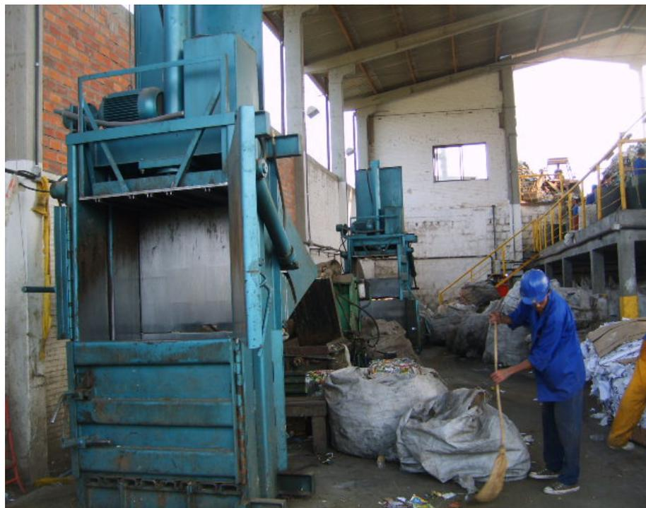
Figura 3.2– Prensa vertical utilizada para compactar rejeito.
