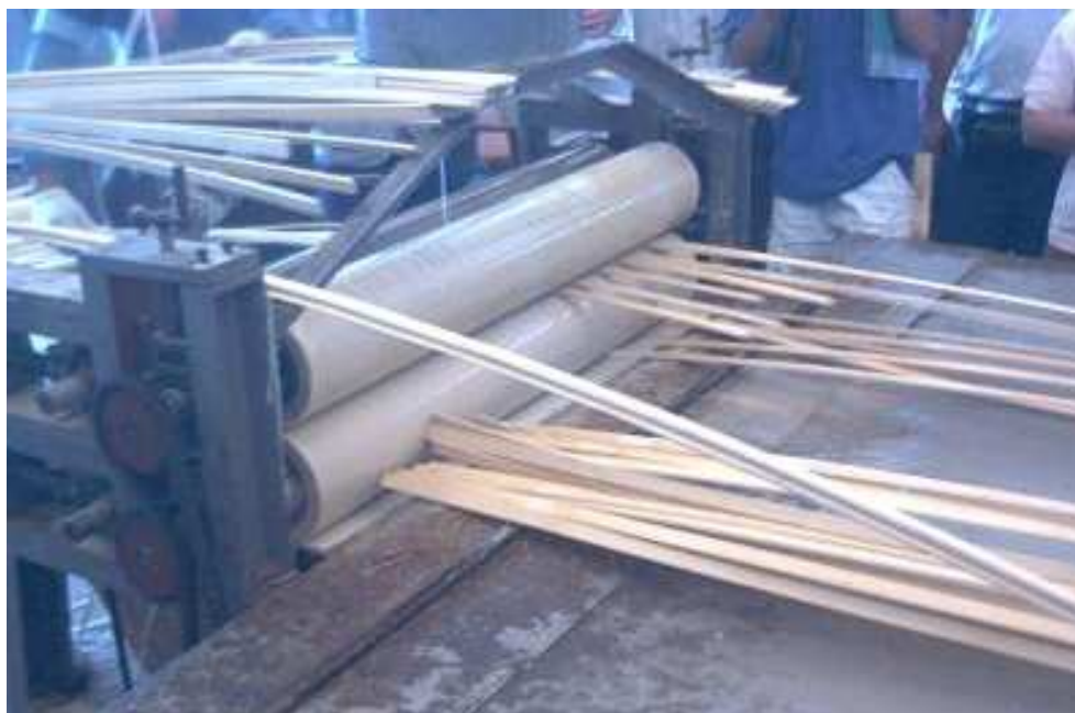
Figura 43 - Processo mecânico de colagem das ripas.
