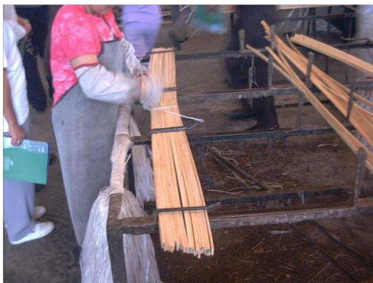
Figura 52 - Colagem manual das taliscas com adesivos. Fonte: PEREIRA; BERALDO. 2007.
