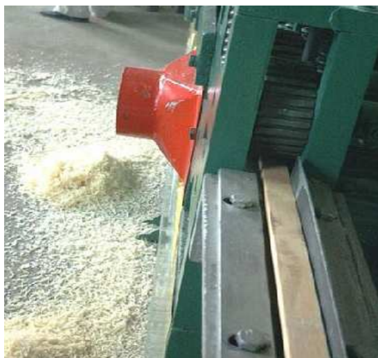
Figura 54 - Obtenção de encaixe macho-fêmea. Fonte: MOIZÉS, 2007, p.39.
