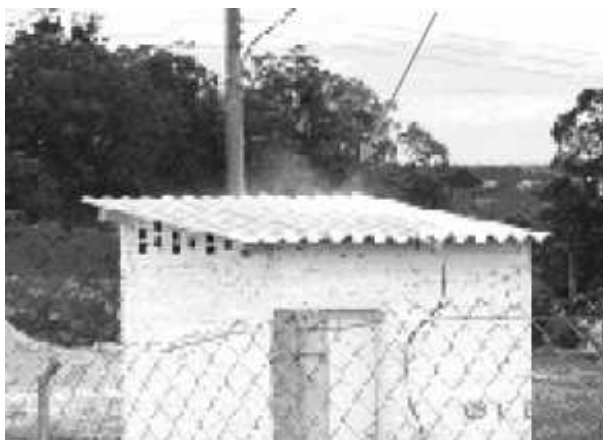
Fig. 7: Protótipo de Ensaio de Campo. (esq.) e Fig. 8: Resultados das temperaturas: F – temp. do ar externo / G – temp. superficial interna da cobertura padrão / I – temp. superficial interna da cobertura com resfriamento evaporativo (dir.).
