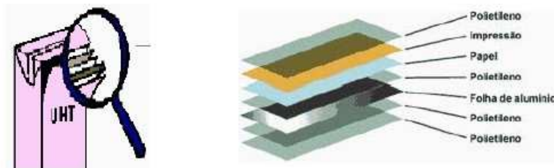
Fig. 12: Composição da embalagem TetraPak. (Fonte: KRÜGER, SUETAKE E ADRIAZOLA, 2005)
