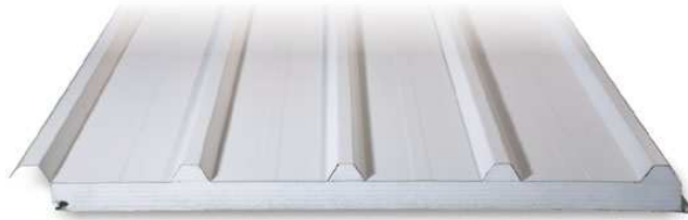
Fig. 85: Telha tipo sanduíche, com lâmina externa de aço pré-pintado na cor branca, núcleo em poliestireno expandido, e revestimento inferior em alumínio fosco, (Fonte: ISOESTE. Disponível em: < http://www.isoeste.com.br >. Acesso em 20.12.2007)
