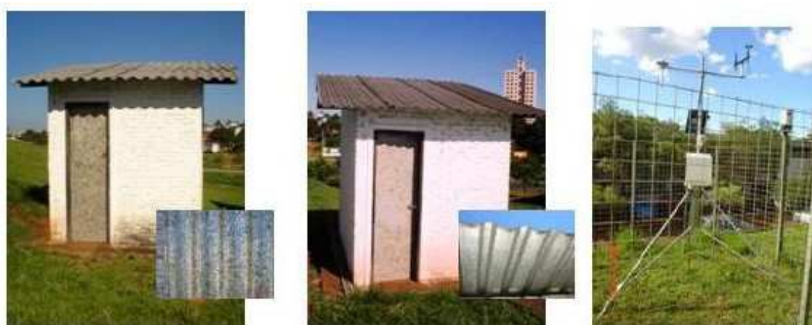
Fig. 9: Protótipo com telha de material reciclado, com telha de aço galvanizado e Estação meteorológica CR10X, respectivamente. (Fonte: PERALTA, 2006)
