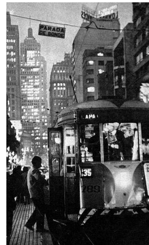
imagem 50. No sistema de bondes, ainda não havia o “ponto físico”, um conceito que foi instalado com o aprimoramento do sistema. Na foto, a indicação da parada é aérea. Av São João, década de 60.
