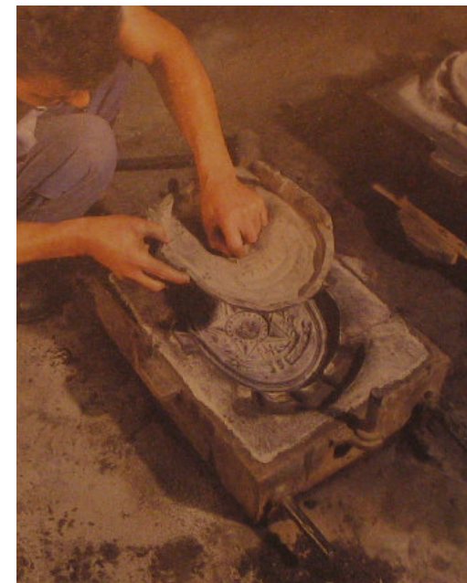
imagem 3. Aspecto artesanal de execução: selo metálico fundido, com brasão da República, que ornamenta os postes do centro de várias cidades brasileiras.
