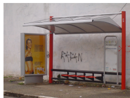
Figura 8: Abrigo modelo Barcelona com bancos, painel informativo e backlight (fonte: SPTrans, 2007)
