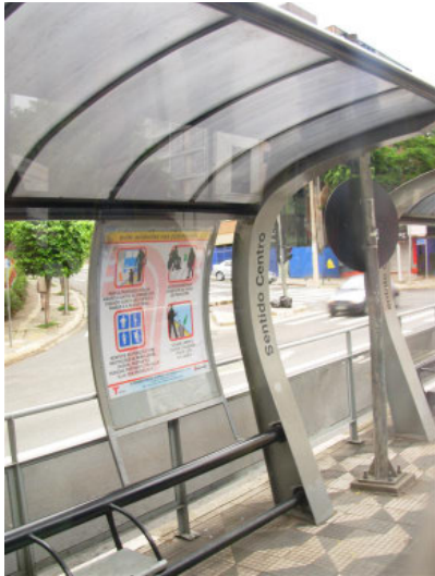
imagem 102. e imagem 103. e imagem 104. Detalhes do SP450: painel informativo curvado, conjunto de luminária, captação pluvial e fotocélula para acionamento automático da luz...
