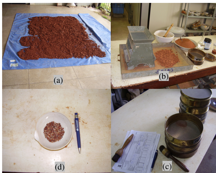
Figura 5.2 – Preparação da amostra e peneiramento. (a) secagem ao ar; (b) quarteamento; (c) peneiramento; (d) quantidade retida.
