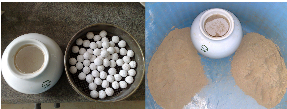
Figura 5.9 – Aspecto do RG aderido às paredes do moinho
