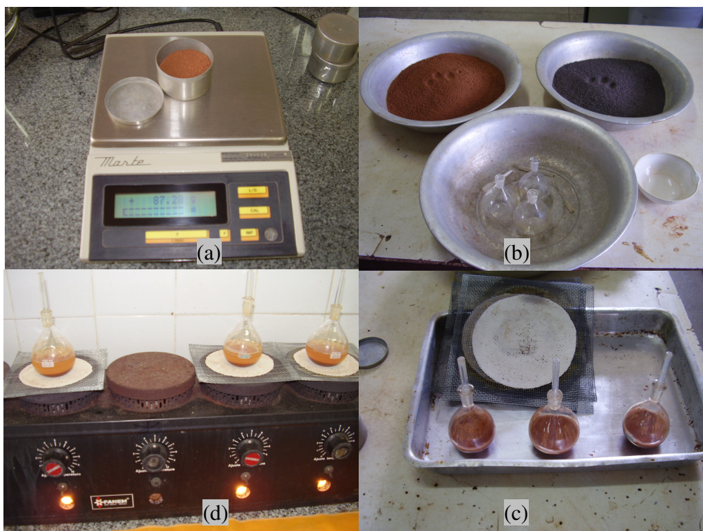
Figura 5.8 – Determinação da massa específica. (a) pesagem da amostra; (b) materiais; (c) amostras prontas para fervura; (d) fervura.
