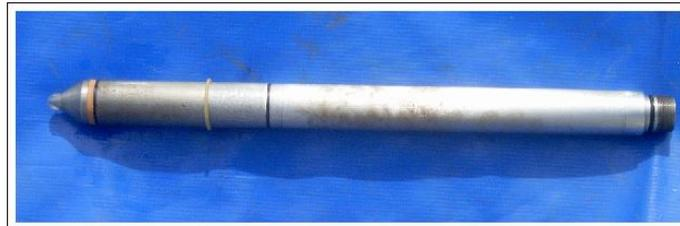
**Figura 3. 5 – Piezocone utilizado no ensaio de campo**
