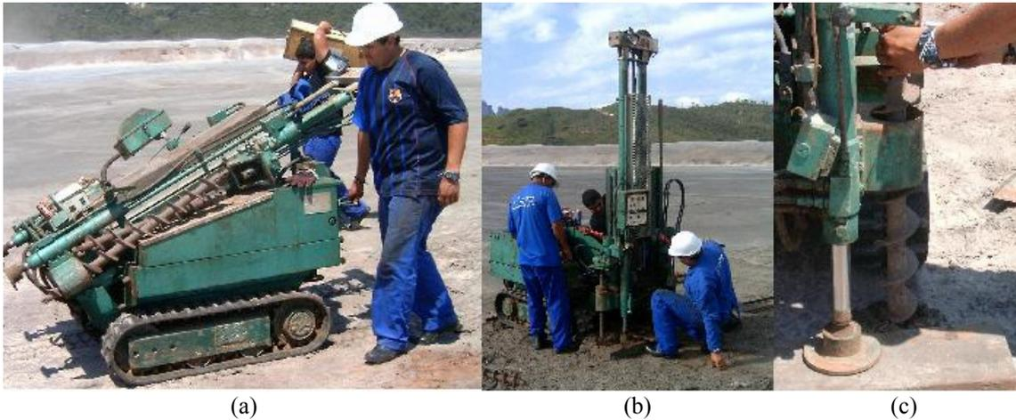
**Figura 3. 4 – (a) Máquina de cravação, (b) montagem do equipamento e, (c) detalhe da ancoragem**
