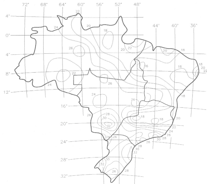
Figura 2.7 – Velocidade básica do vento (NBR 5422:1985).
