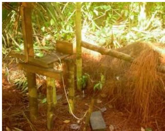
Figura 15. Imagens do processo de beneficiamento, coletor cortando o feixe de fibras sobre a forma, ao fundo molde para formação da tora (direita). Pente e forma para pentear as fibras, fundo resíduos do processo. (Oliete 2007)
