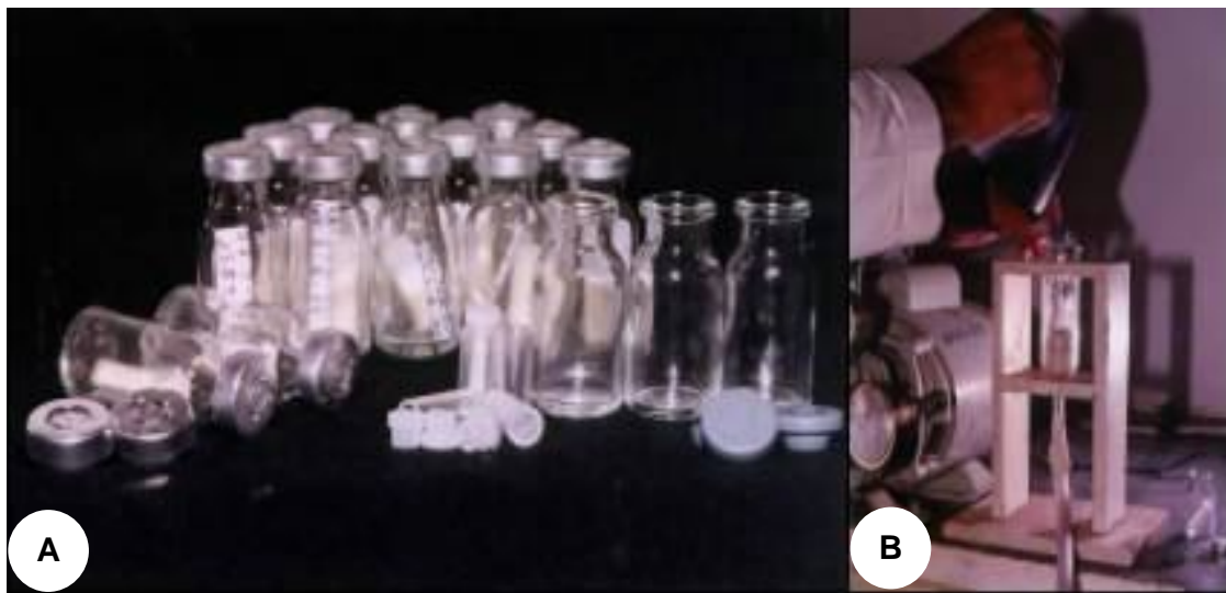
Figura 7 – Acondicionamento do pólen. A. Frascos para o armazenamento de pólen. B. Equipamento para fechamento dos frascos a vácuo. Embrapa Amazônia Ocidental.
