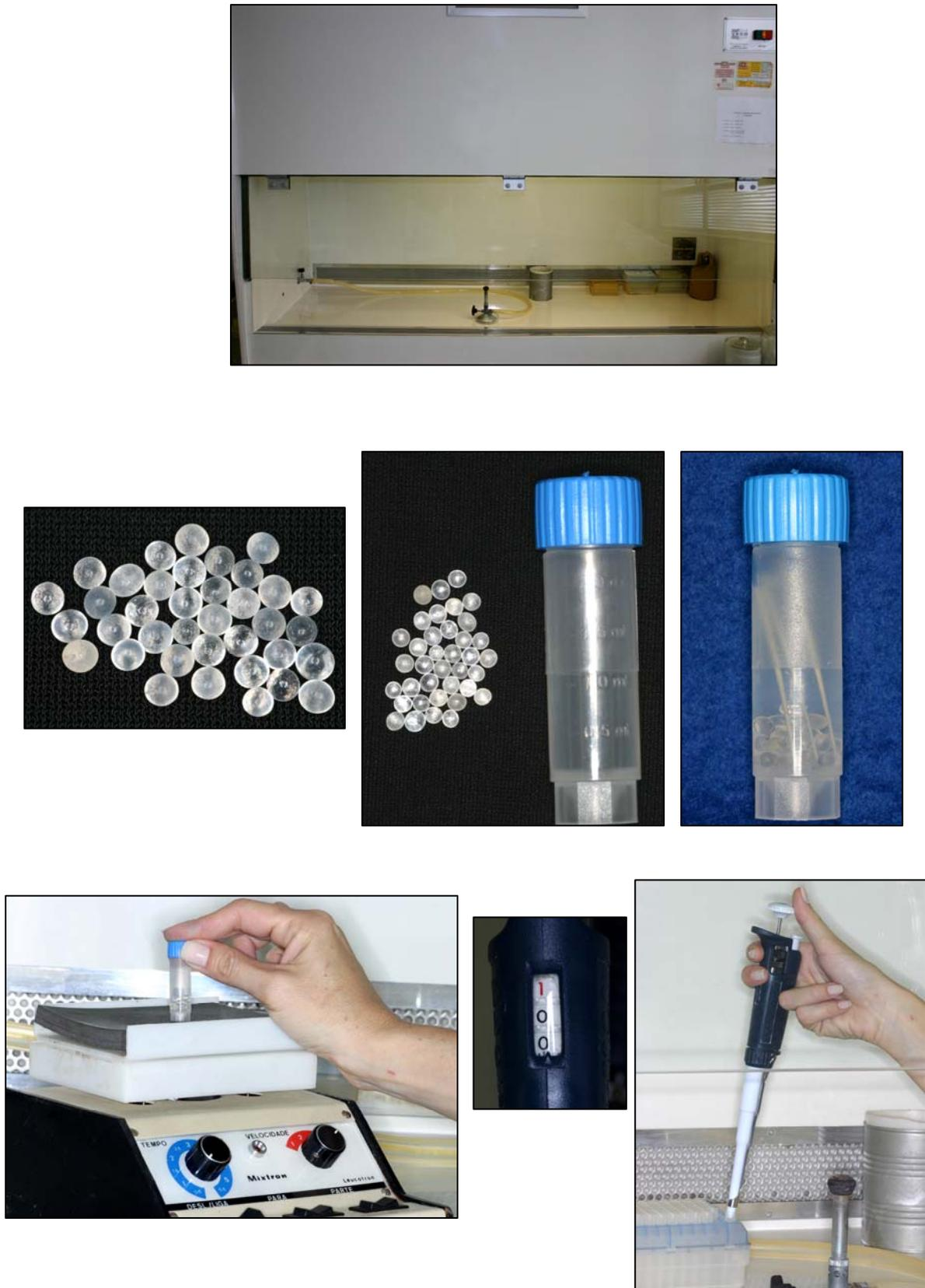
FIGURA 9: fluxo laminar; criotubo + pérolas de vidro + cones de papel; dessorção; pipeta e ponteira esterilizada.
