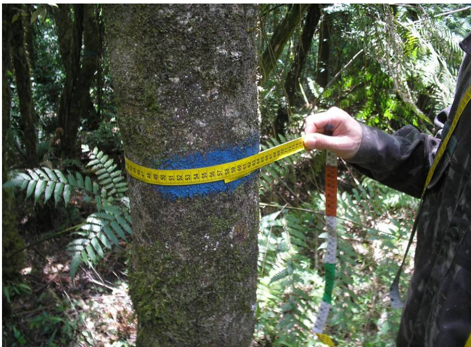
Figura 5 - Medição da circunferência à altura do peito - CAP das árvores com fita métrica.
