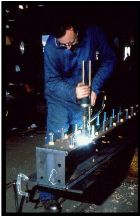
Figura 2.7 – Soldagem de conectores de cisalhamento. (ESDEP, 1996)
