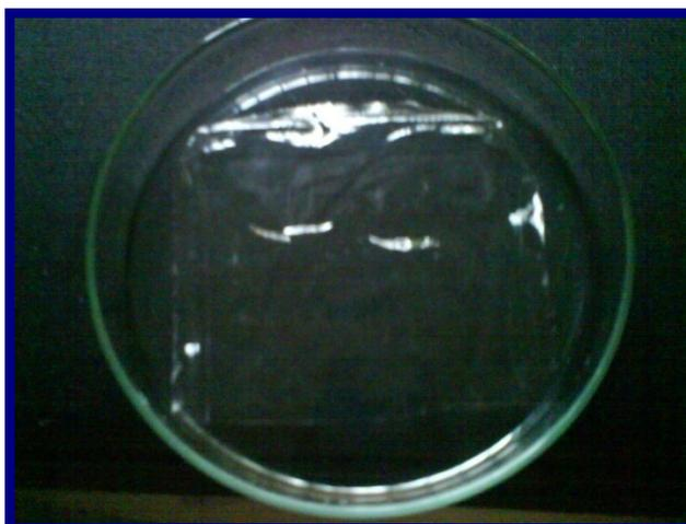
**Figura 25** - Filme de PVA obtido a partir de dispersão formada por 60% de etanol e 40% de água. Concentração de PVA = 0,8% m/v.
