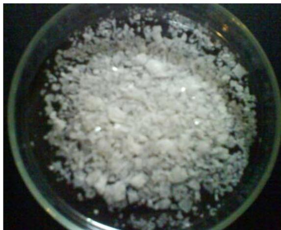
**Figura 26** - Material obtido a partir de dispersões aquosas de polietilenoglicol (PEG) de concentração igual a 2% (m/v).
