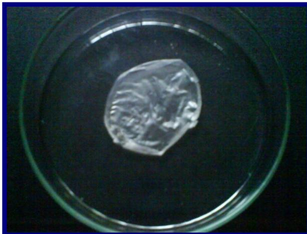
**Figura 30** - Filme obtido a partir da dispersão formada por etanol 70% (v/v) e água 30%, (v/v), contendo PEG (0,3%, m/v) e PVA (0,7%, m/v), após secagem em estufa a 50°C.
