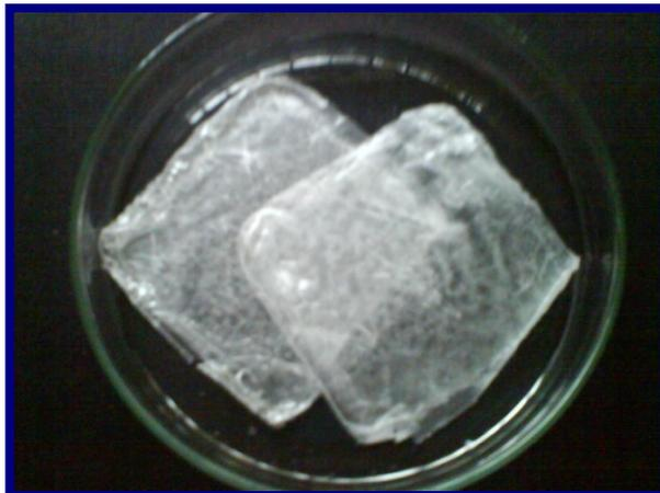
**Figura 29** - Filme obtido a partir da dispersão formada por etanol 70% (v/v) e água 30%, (v/v), contendo PEG (1,5%, m/v) e PVA (0,5%, m/v), após secagem em estufa a 50°C.
