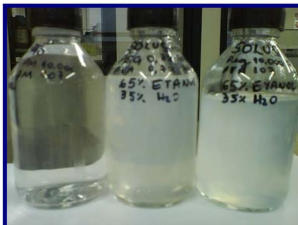
**Figura 22** - Dispersões contendo 65% de etanol e 35% água (v/v) e teores variados de PEG e PVA: (esquerda) 0,7% PVA/ 0,3% PEG; (centro) 0,2% PVA/ 0,8% PEG e (direita) 0,5% PVA/ 0,5% PEG. Em todos os casos, a concentração total dos polímeros foi de 1% (m/v).
