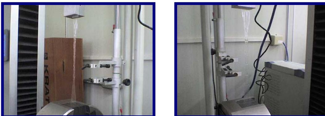
**Figura 13** - Filme moldado na forma de gravata em execução dos ensaios de resistência mecânica sob tração.
