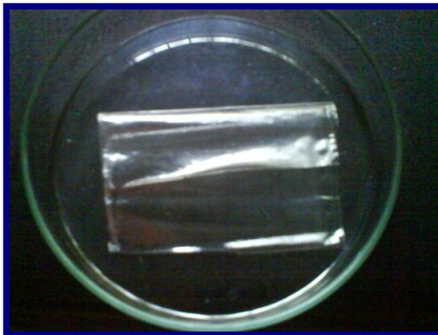
**Figura 24** - Filme de PVA obtido a partir de dispersão formada por 70% (v/v) de etanol e 30% (v/v) de água. Concentração de PVA = 0,7% m/v.
