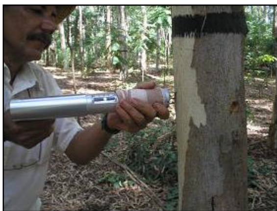
Figura 2. Mensuração da resistência à penetração na madeira de Eucalyptus camaldulensis , com aparelho Pilodyn Wood Tester .
