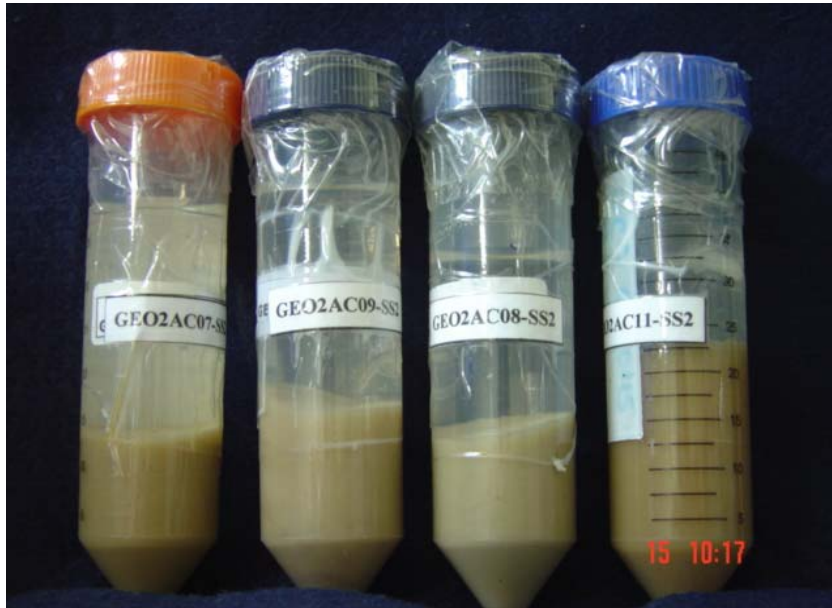
Figura 10 - Sedimentos em suspensão (suspensatos) em frascos cônicos após floculação com sulfato de alumínio.
