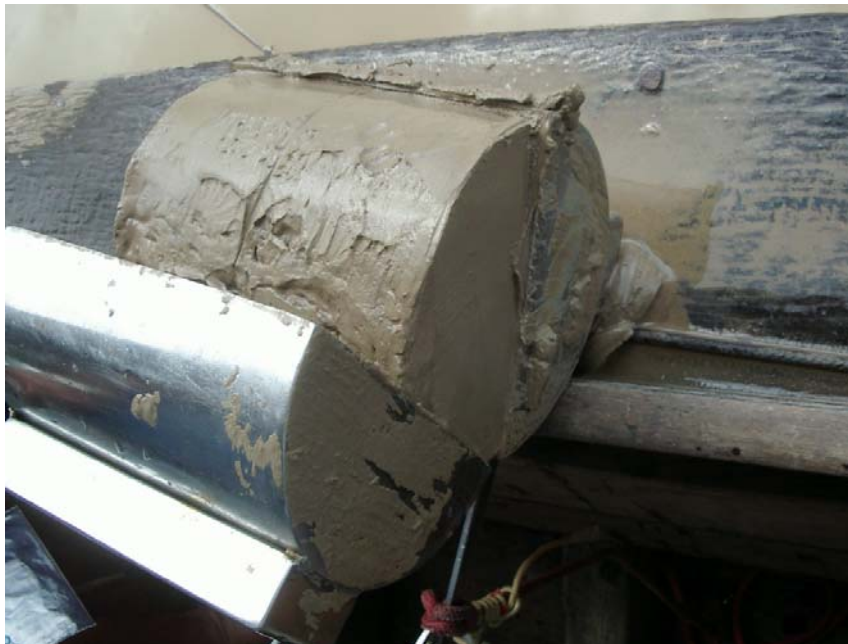
Figura 11- Amostrador de van Veen com amostra de sedimento de fundo coletada no rio Envira.
