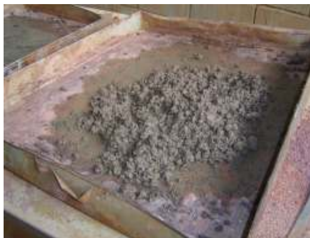
Figura 3.12- Mistura de BGS com material fresado e cimento Portland.
