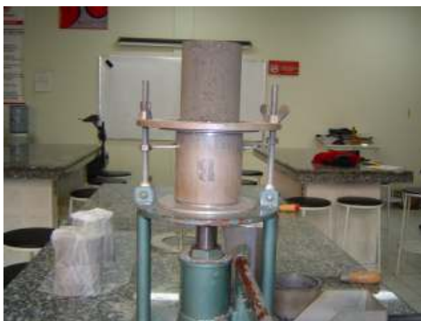
Figura 3.3- Corpo de prova sendo desmoldado em um extrator hidráulico.
