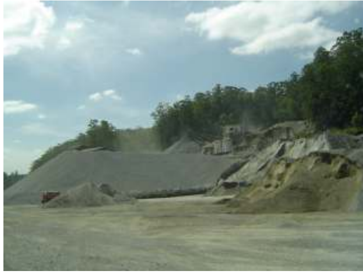
Figura 2.2- Depósito de brita e pó de pedra- Pedreira de Embu, em São Paulo.
