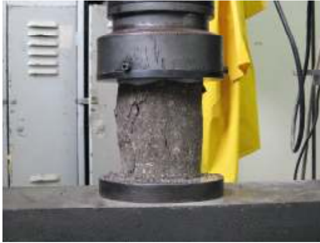
Figura 3.20- Corpo de prova na prensa após ruptura no ensaio de resistência à compressão simples.
