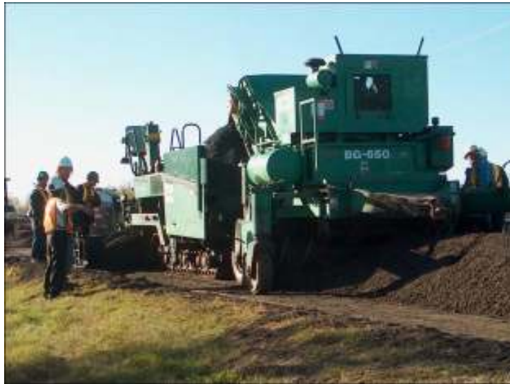
Figura 2.17- Reciclagem a frio com recicladora BG-260, Martec. Fonte: Martec.
