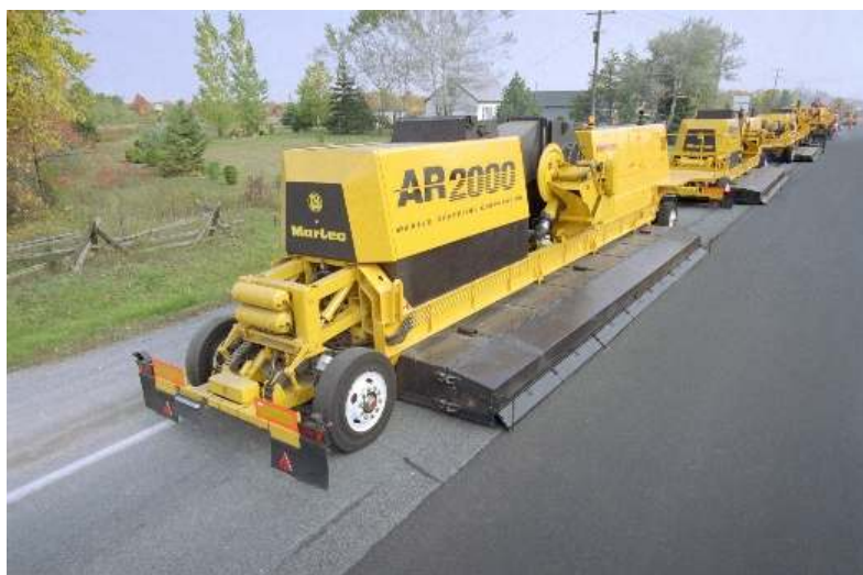
Figura 2.6- Recicladora in situ a quente- AR 2000- Martec. Fonte: Martec (2006).
