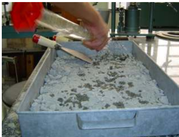
Figura 3.2- Preparo da mistura para moldagem dos corpos de prova.
