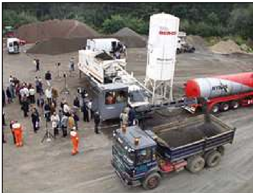
Figura 2.16- Mobile mixing plant KMA 200. Fonte: Wirtgen América (2006).
