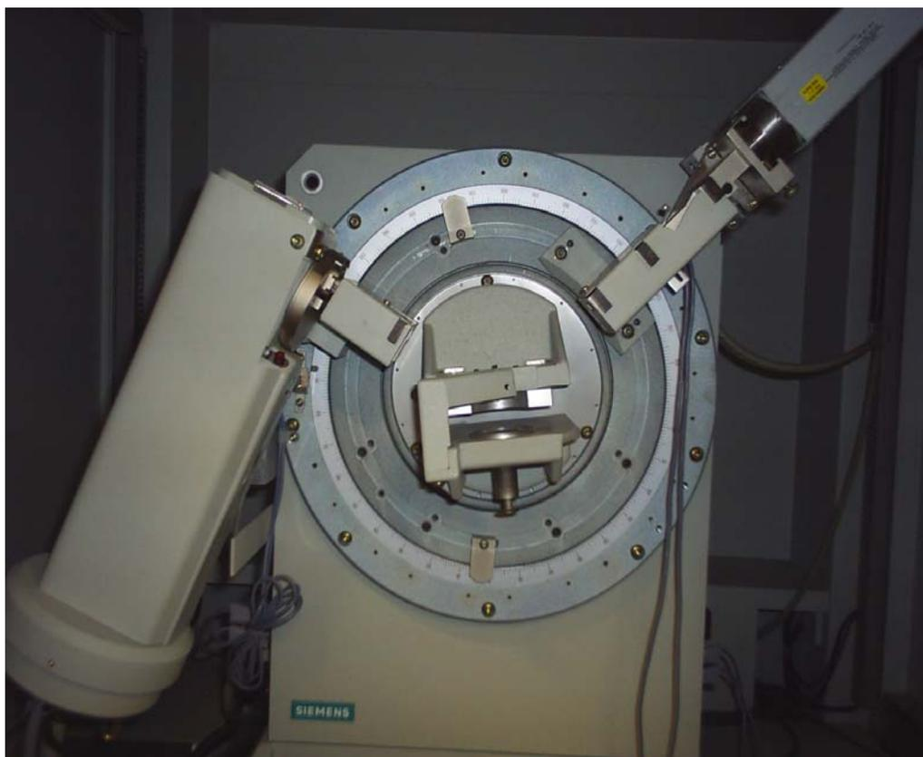
Figura 4.4 Difratômetro de Raio X, modelo Siemens D5005.
