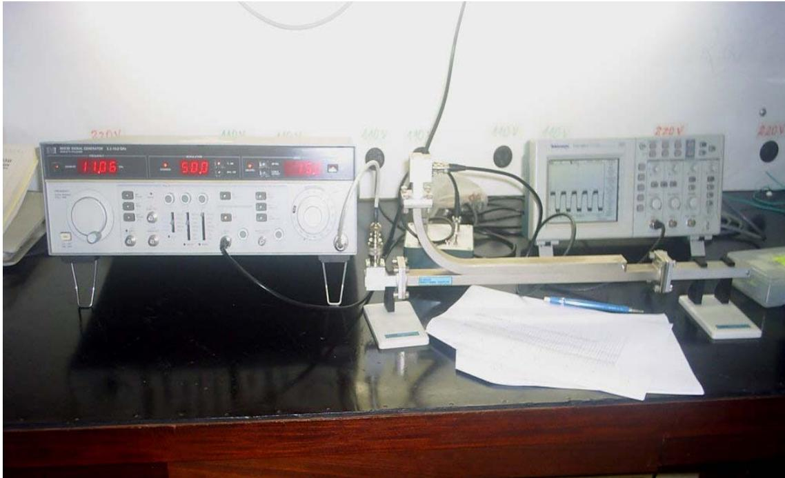
Figura 4.9 Instrumentação para medidas de refletividade por guia de ondas.
