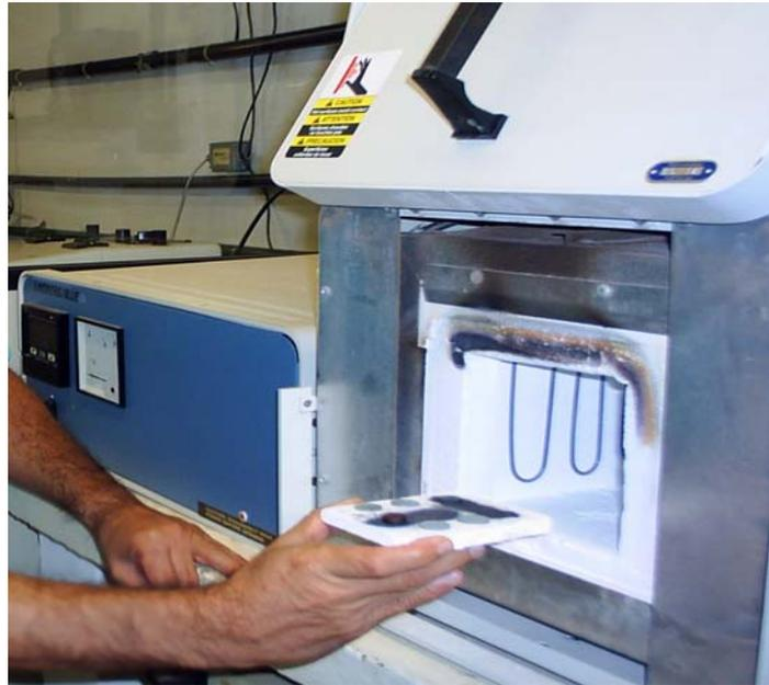
Figura 4.6 Forno Programável Lindenberg usado na sinterização das amostras.
