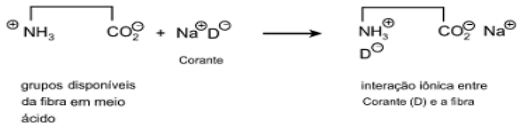
Figura 4. Exemplo genérico da interação iônica entre o corante (D) e os grupos amino da fibra da lã.
