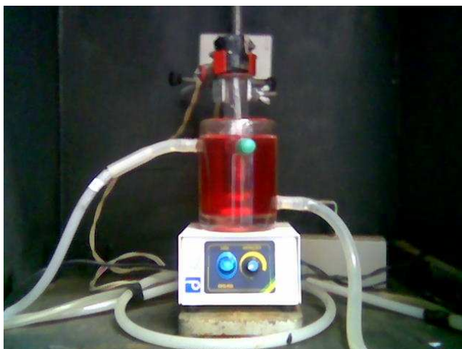
Figura 14 Fotografia do equipamento utilizado para o processo oxidativo UV/H 2 O 2 .
