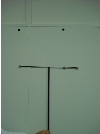
Figura 19 – Foto do bastão utilizado na calibração dinâmica.
