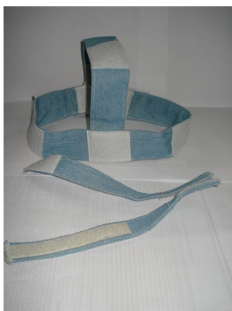
Figura 13 – Foto do capacete de tecido confeccionado para a fixação de marcadores na cabeça.
