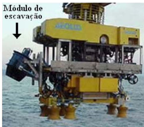
Figura 3.21 – Modulo de escavação NorthshorePropulsion
