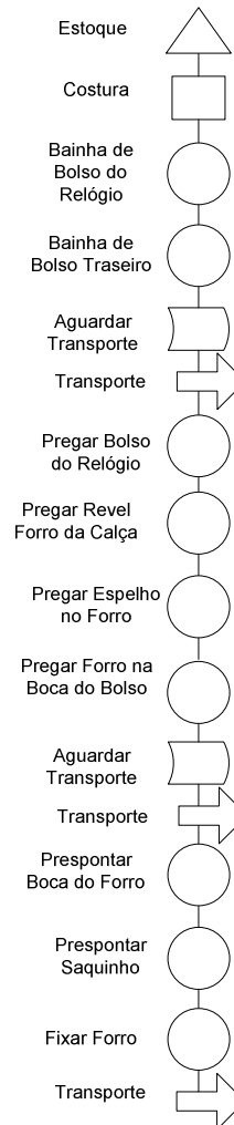
FIGURA 4.3 – Fluxograma de Montagem da Frente de uma Calça Fonte: Do autor.
