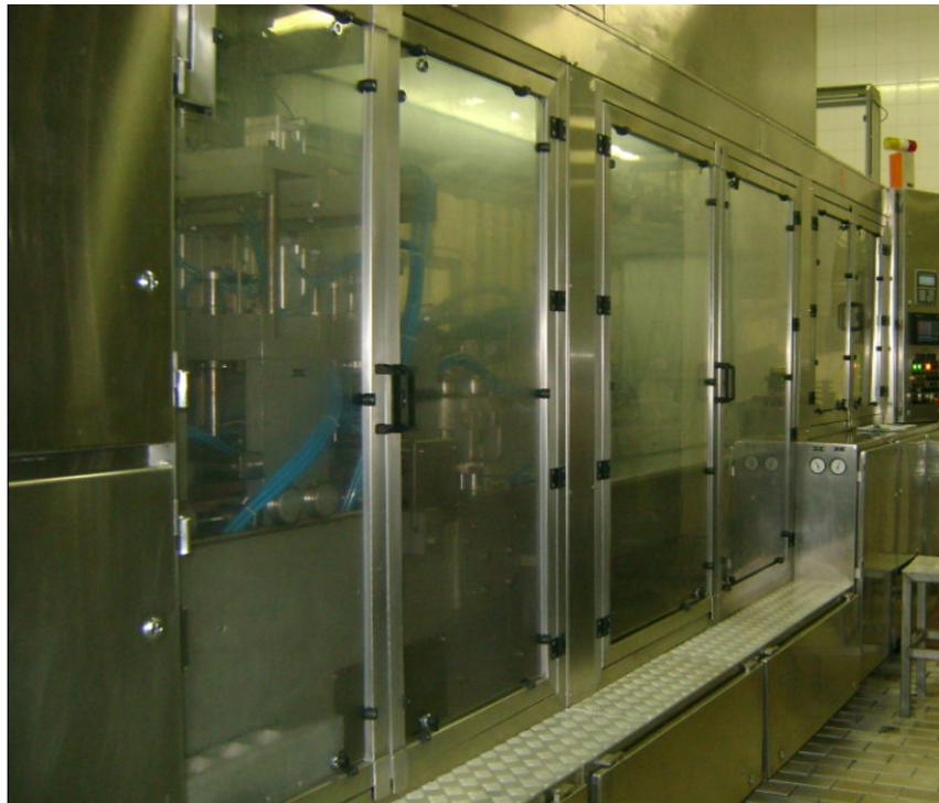
FIGURA 10: Vista geral de uma máquina termoformadora.
