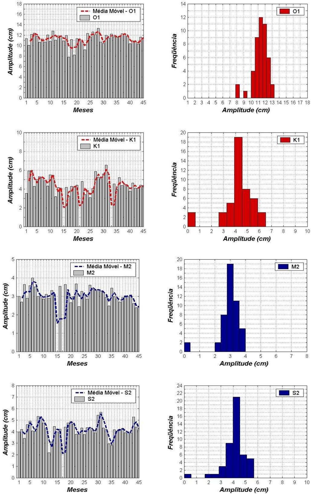
Figura 5.4 - Histogramas e médias móveis dos componentes harmônicos O<sub>1</sub>, K<sub>1</sub>, M<sub>2</sub> e S<sub>2</sub>.
