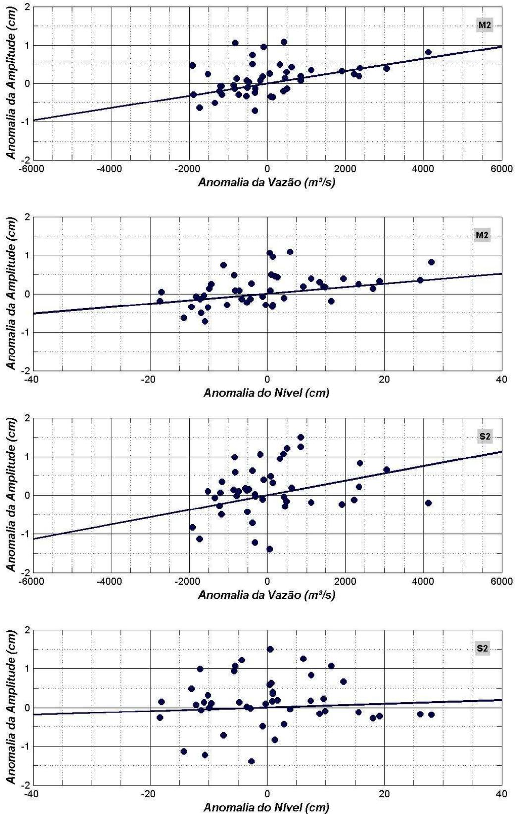
Figura 5.15 - Diagramas de dispersão das anomalias das amplitudes da M<sub>2</sub>, e S<sub>2</sub>, da vazão e do nível médio.
