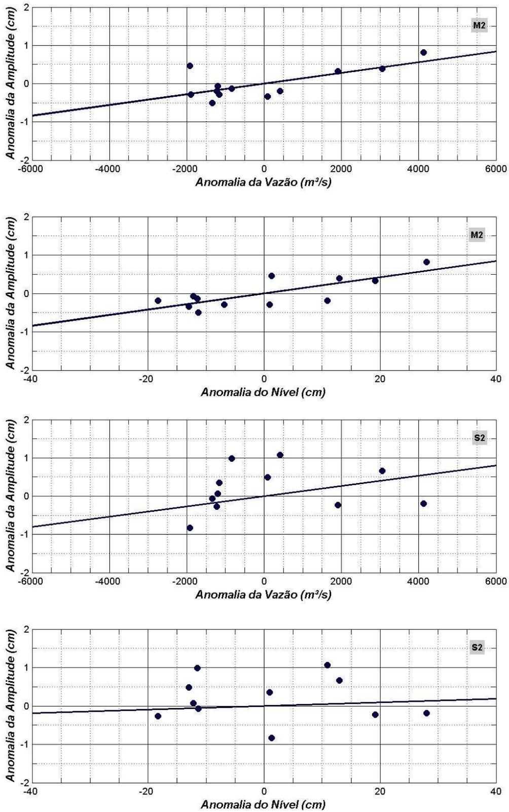
Figura 5.9 - Diagramas de dispersão das anomalias obtidas através dos desvios médios da  $M_2$  e  $S_2$ , da descarga fluvial e do nível médio para o ano de 1984.
