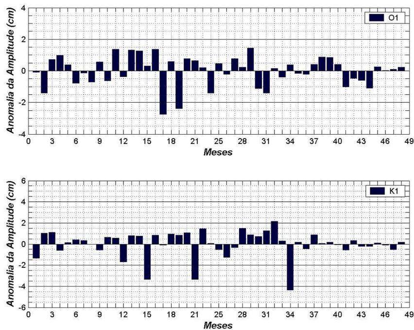
Figura 5.13 (a) - Anomalias de amplitude dos componentes diurnos e semidiurnos ( $O_1$  e  $K_1$ ).
