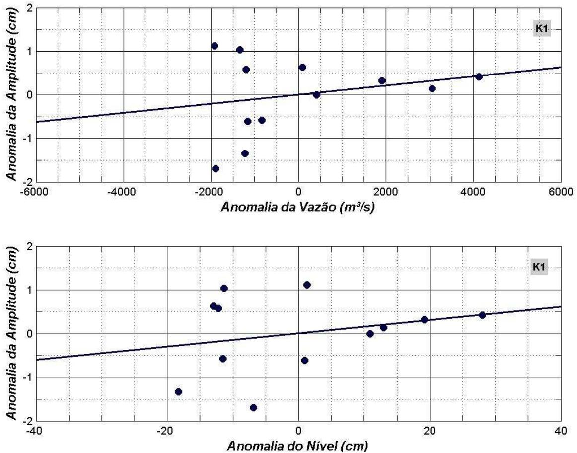
Figura 5.8 - Diagramas de dispersão das anomalias obtidas através dos desvios médios da K<sub>1</sub>, da descarga fluvial e do nível médio para o ano de 1984.
