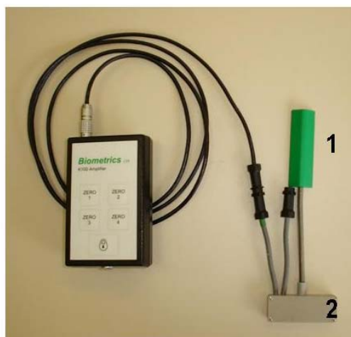
Figura 15. Eletrogoniômetro biaxial de tornozelo (1= bloco móvel, 2 = bloco fixo).
