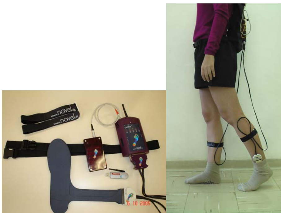
Figura 11. Pedar X System, bateria, condicionador (box) com cabos para conexão nas palmilhas, fitas para fixação do equipamento no sujeito e dispositivo bluetooth. Situação exemplar do sujeito com as palmilhas colocadas dentro de meias antiderrapantes, usando a mochila nas costas contendo o condicionador do Pedar X.
