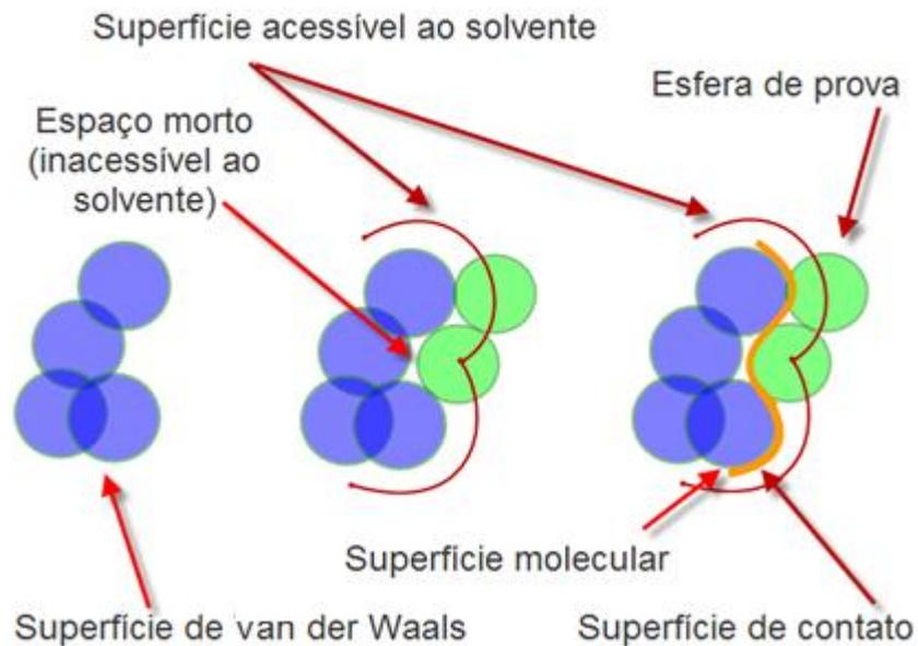
**Figura 22.** A superfície de Van der Waals corresponde ao contorno da superfície definidas pelos raios de van der Waals dos átomos. A superfície molecular é gerada rolando-se uma esfera de prova (geralmente de raio 1.4 Å, representando a molécula de água) sobre a superfície de van der Waals. O centro da esfera de prova traça a superfície acessível ao solvente (Adaptado de: LEACH, 2001).
