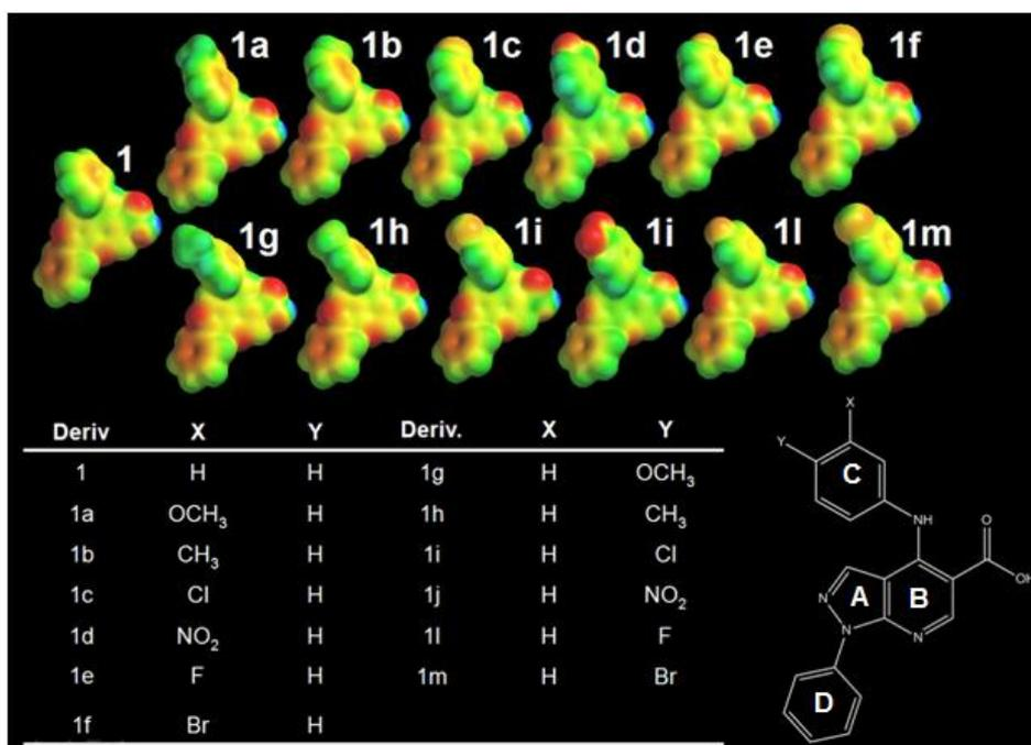
Figura 37. Mapa de potencial eletrostático dos derivados da série 1 (1, 1a-m) sobre uma *isosurface* de 0,002 eV/ua<sup>3</sup> e faixa de -25 a +55 kcal/mol.
