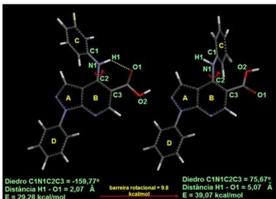
**Figura 27. Comparação entre as conformações de menor (esquerda) e de maior (direita) energia para o derivado 1e (*m*-F) da série 1. A linha tracejada entre H1<---->O1 representa a ligação hidrogênio intramolecular.**
