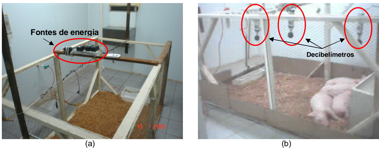
Figura 23 - Instalação e fixação de fontes de energia elétrica para os decibelímetros (a). Disposição dos decibelímetros no interior da câmara climática (b)
