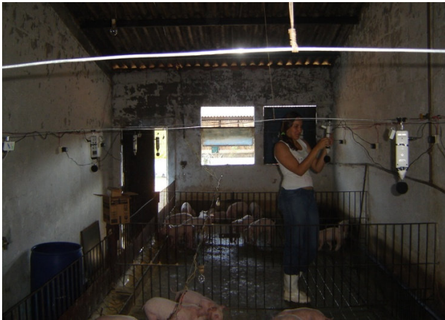
Figura 8 - Programação dos decibelímetros em campo
