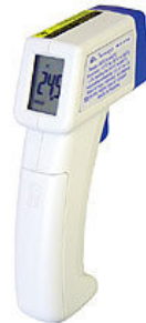
Figura 27 - Detalhe do termômetro de infravermelho utilizado para coletar a temperatura de superfície de pele dos leitões
