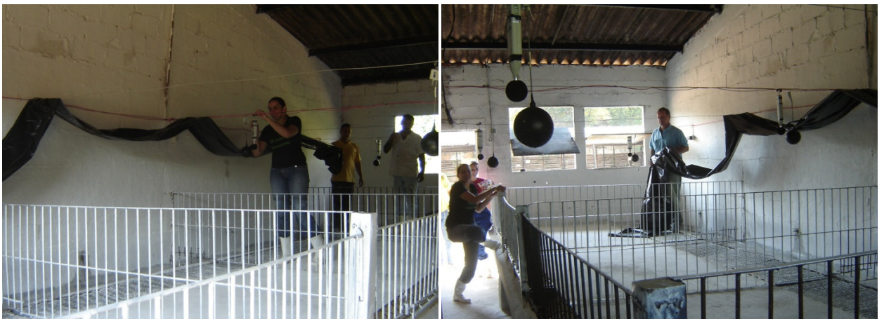
Figura 10 - Fotos da instalação dos 5 decibelímetros ( layout 2 ) no interior da sala de creche de suínos, na distribuição em zigue-zague
