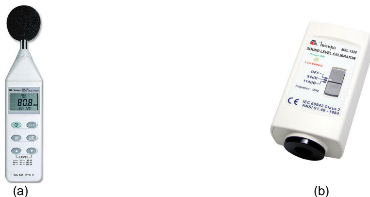
Figura 6 - Equipamento utilizado para captar os dados de pressão sonora (ruído) dos animais - Decibelímetro (a) e equipamento utilizado para calibrar os decibelímetros - Calibrador de Nível Sonoro (b)
