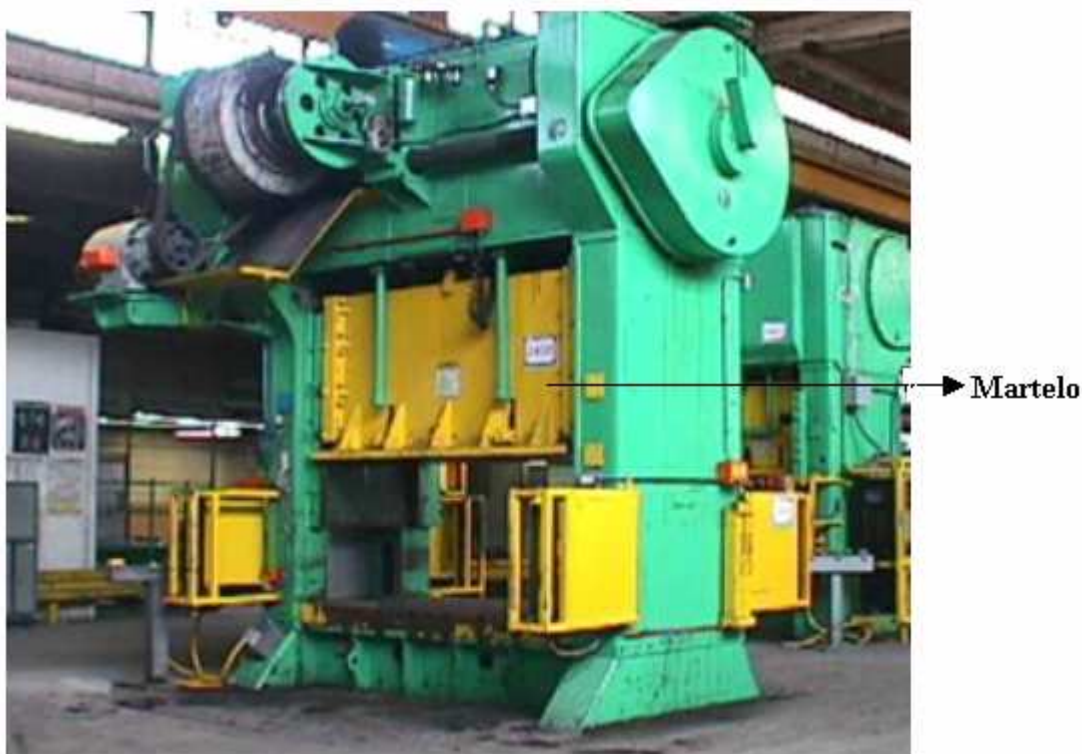
FIGURA 1 – Prensa com demonstração do martelo
