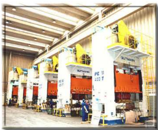
Linha de carroceria P2C - 4P - 400 ton. Mesa de trabalho 3000 x 1800 mm. Com mesa fixa ou móvel
