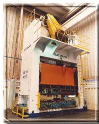
P2C - 4P - 800 ton. Mesa de trabalho 4150 x 2300 mm. Com mesa fixa ou móvel
