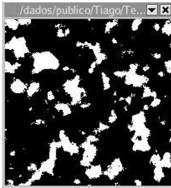
Figura A.10: Janela mostrando um objeto do tipo imagem tridimensional. Apenas um plano da imagem tridimensional é mostrado, onde a fase porosa é representada pela cor branca e a fase sólida pela cor preta.
