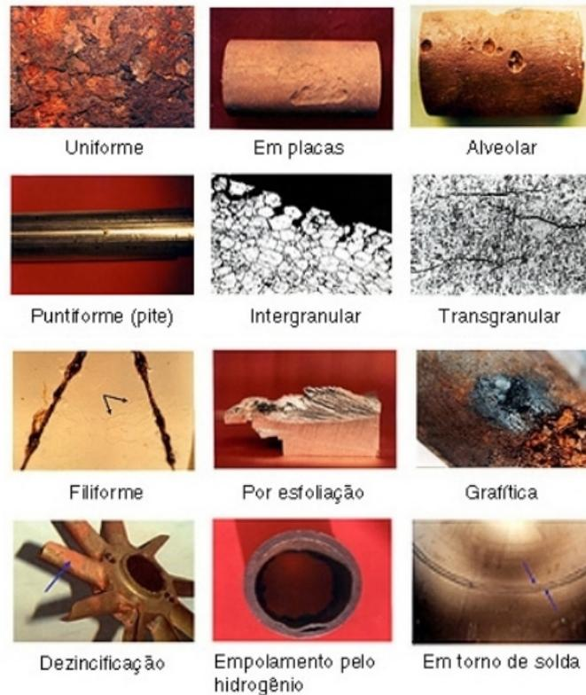
FIG. 28 Exemplos das diferentes formas de corrosão (GENTIL, 2007, p. 44).
