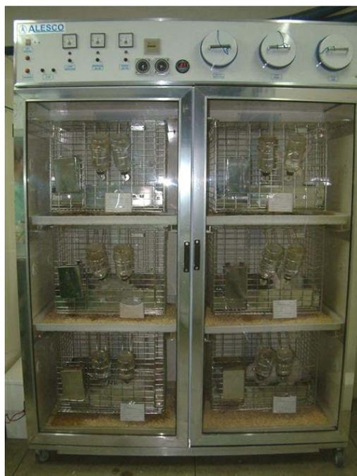
FIG. 34 Estante com gaiolas individuais, controle de temperatura e sistema de filtragem de ar.
