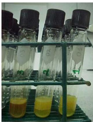
FIG. 37 Tubos de vidro com amostras em processo de digestão em HNO<sub>3</sub> a 65%.
