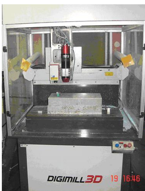
Figura 9: Digitalizadora a Laser - (Digimil 3D, Tecnodrill®).
