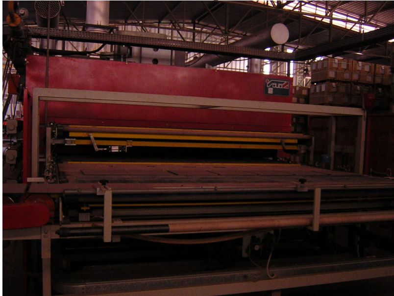
Foto 7 – Entrada das placas no secador
