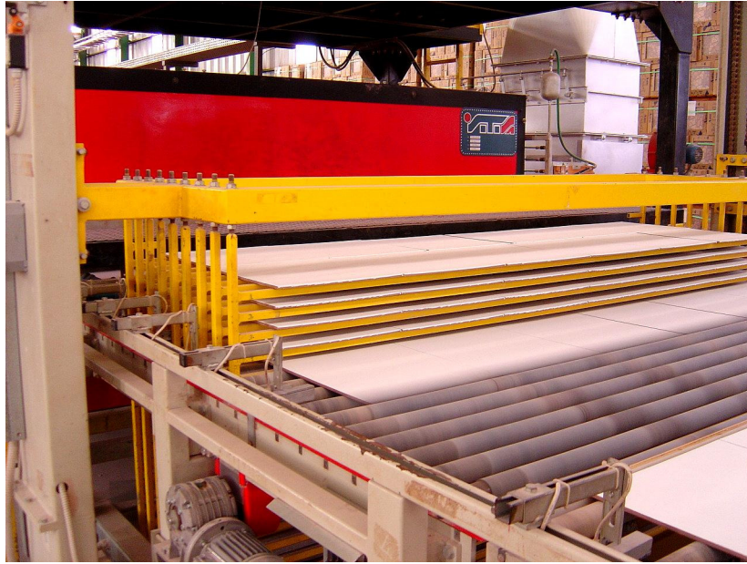
Foto 15 – Entrada do forno
