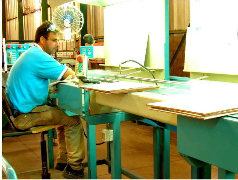
Foto 19 – Inspeção e classificação visual das placas
