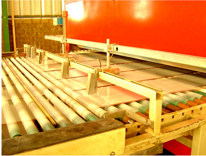
Foto 17 – Saída das placas do forno
