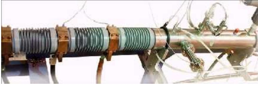
**Figura 1- Protótipo de cabo supercondutor desenvolvido em laboratório.**
