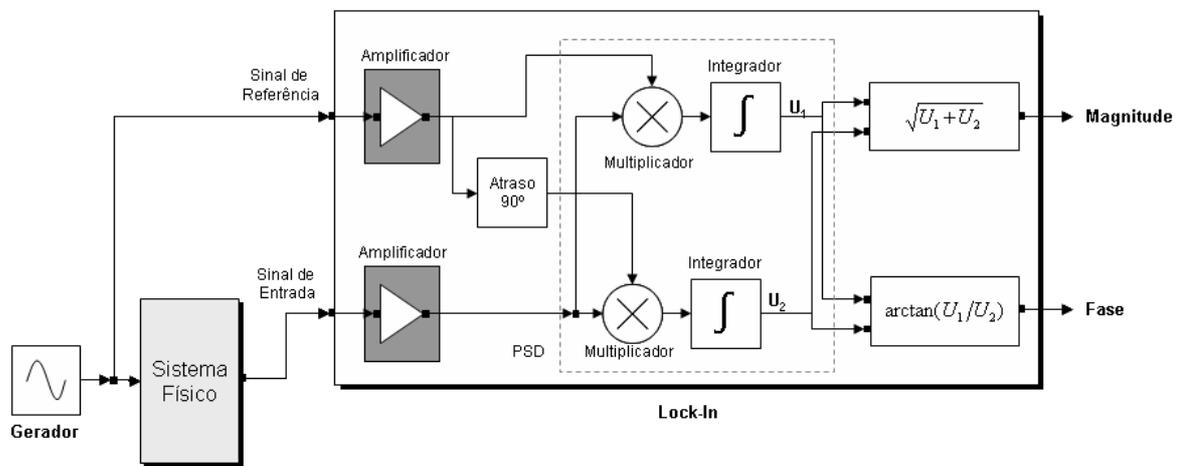
Figura 3 - Configuração básica de um amplificador Lock-in
