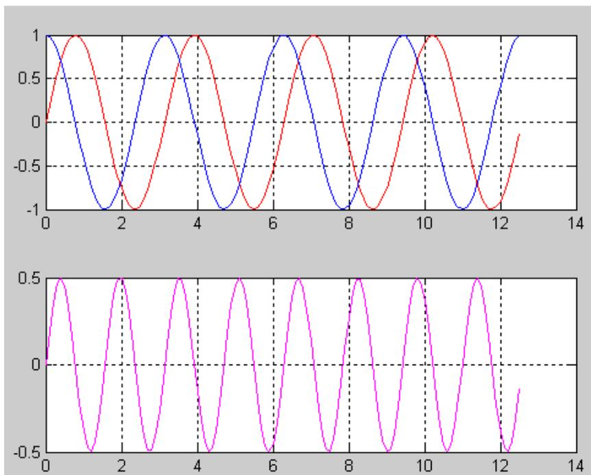
**Figura 5 - Parte superior mostra os sinais de entrada (azul) e a referência (vermelho) com defasagem de  $90^\circ$ . Parte inferior mostra o sinal de saída após a multiplicação do sinal de entrada por  $V_{ref}$ .**
