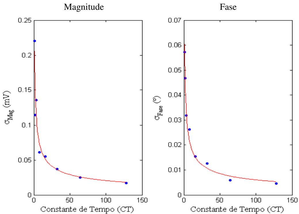
**Figura 20 - Comportamento do desvio padrão do ruído da medida em função do tempo de integração. Simulação com Ruído=0.0005 Vp e freq = 2 MHz.**
