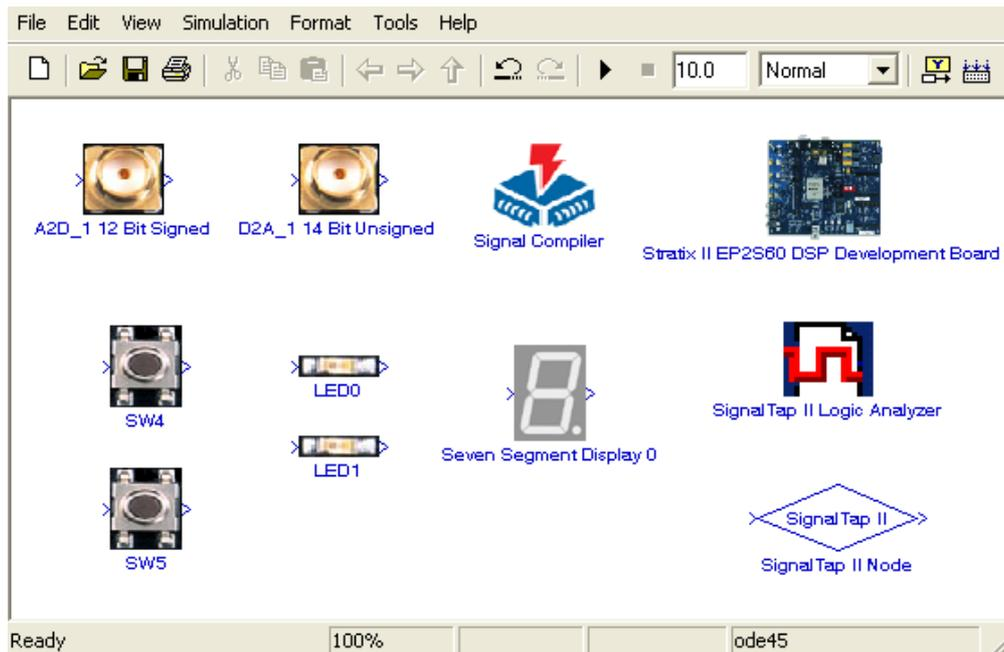
**Figura 23 - Principais blocos utilizados na programação do kit EP2S60.**
