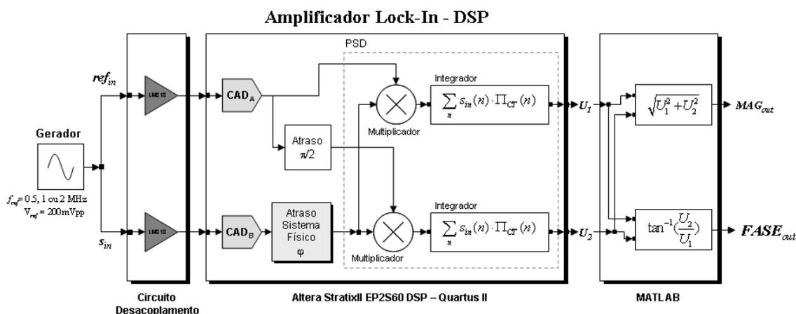
Figura 21 - diagrama de blocos do experimento para medir a magnitude ( $MAG_{OUT}$ ) e a fase  $FASE_{OUT}$  de sinais reais
