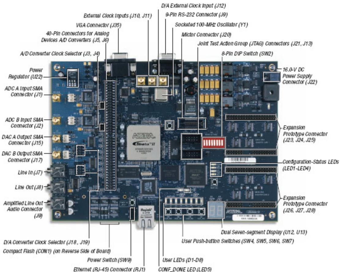
**Figura 6 - Layout dos componentes e interfaces do kit Altera Stratix II EP2S60 DSP.**
