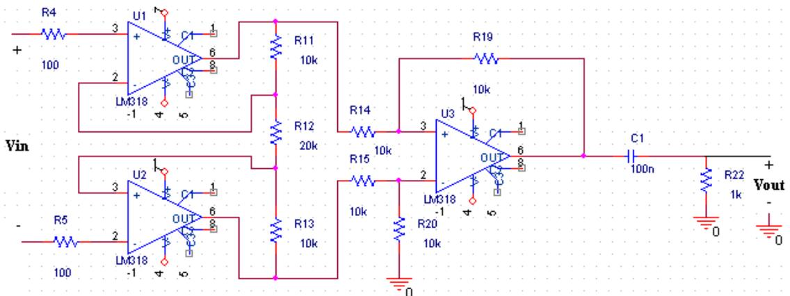
**Figura 11 - Circuito de desacoplamento. O projeto dividiu o circuito em três estágios: Estágio de amplificação diferencial com dois amplificadores operacionais LM318, um estágio de ajuste de ganho e um filtro passa-altas. Este circuito foi construído duas vezes sendo um utilizado para o sinal de medido e outro para o sinal de referência.**
