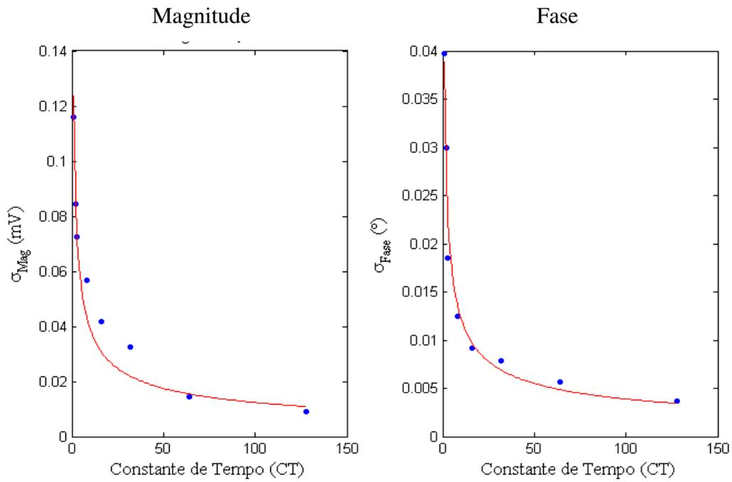
**Figura 19 - Comportamento do desvio padrão do ruído da medida em função do tempo de integração. Simulação com Ruído=0.0005 Vp e freq = 1 MHz.**
