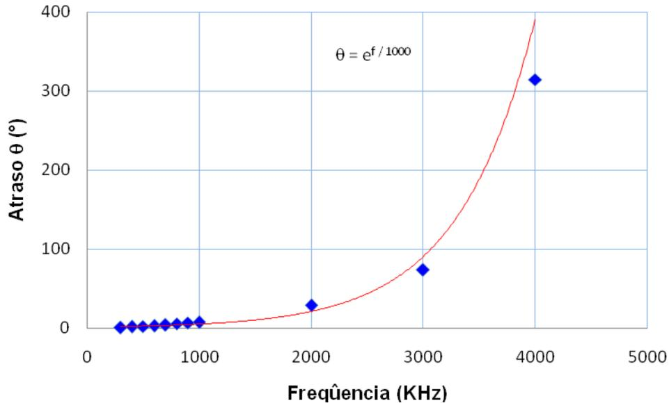
Figura 13 - Análise do atraso do sistema em função da variação de frequência.
