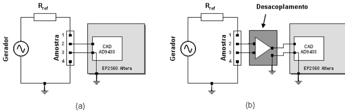
**Figura 10 – (a) Mostra o gerador ligado diretamente a amostra e o terra comum no sistema de medição a 4 fios. (b) Mostra o circuito desacoplando o terra da fonte com a amostra a 4 fios.**
