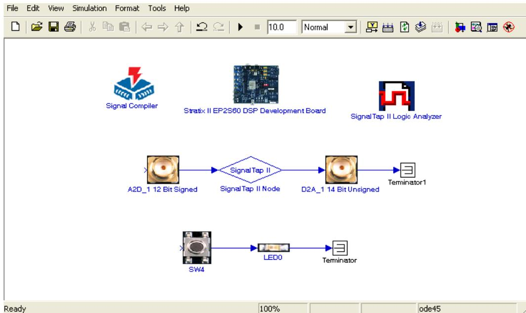
**Figura 24 - Programa básico de demonstração de como utilizar os blocos de programação do kit de desenvolvimento. O sinal entra no conversor A2D de 12 bits, passando pelo “node” de leitura de sinal do SignalTap e retorna para a saída pelo conversor D2A de 14 bits.**
