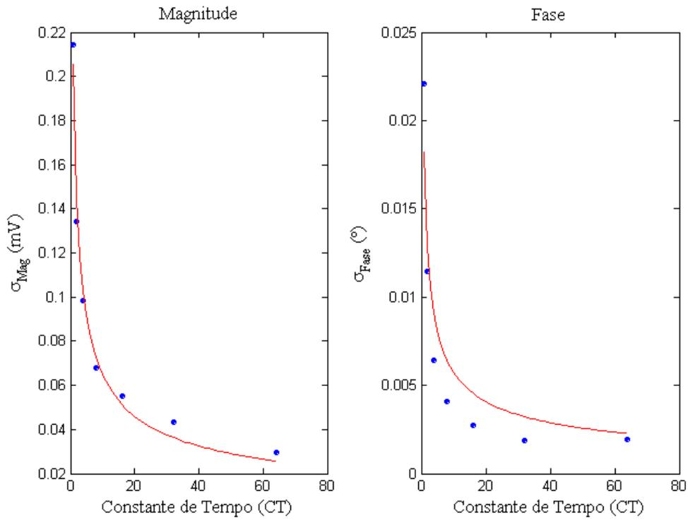
**Figura 34 - Comportamento do desvio padrão da medida em função do tempo de integração. Medida com fref = 0.5MHz.**
