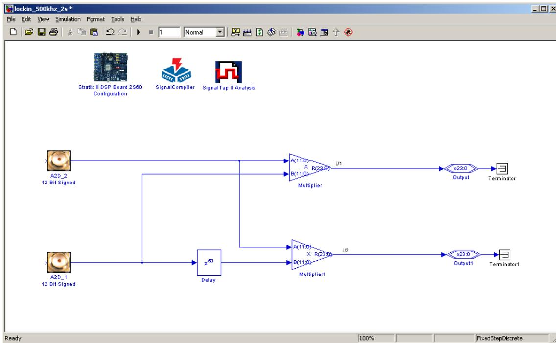
**Figura 32 - Circuito PSD (Sistema de Detecção Sensível a Fase) do Lock-In utilizando o Simulink e as bibliotecas da Altera.**
