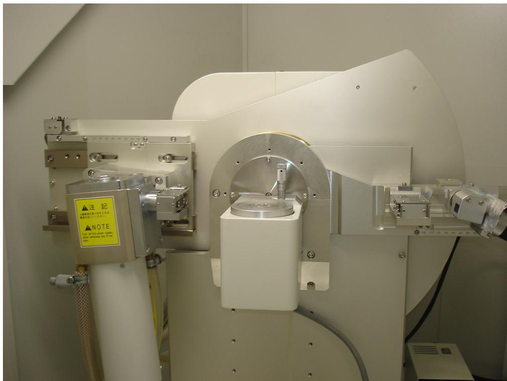
Figura 16. Equipamento para a técnica de XRD empregado.
