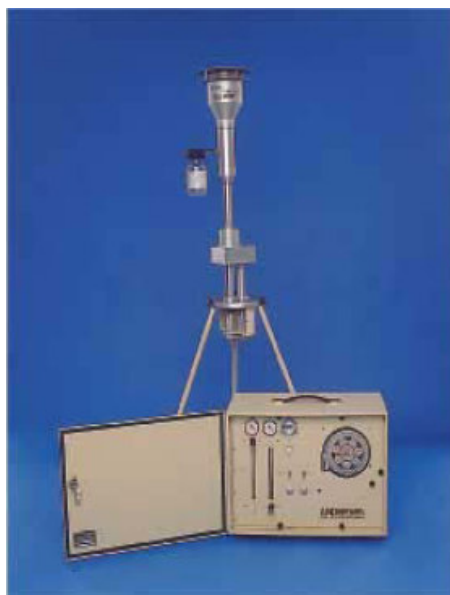
Figura 2.10- Amostrador de pequenos volumes, Dicotômetro, marca Andersen (Energética, 2006).
