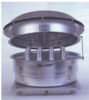
Figura 3.6 – Cabeça de separação inercial do AGV- MP 10 . Fonte: Energética.
