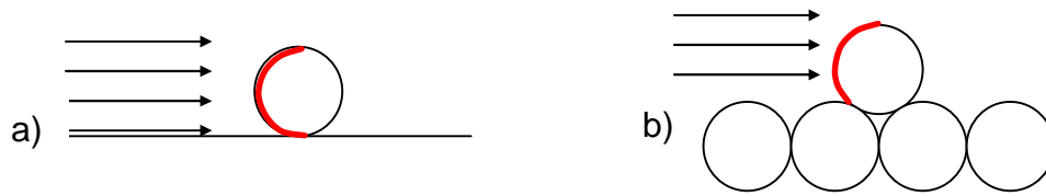
Figura 21. Região de atuação da força de arraste provocada pelo fluxo transversal. a) conforme reportado por O'Neill (1968) e b) deposição de partículas no reboco.
