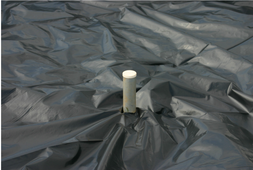
Figura 8 - Visualização de um ponto estudado com a colocação do plástico após a saturação do perfil
