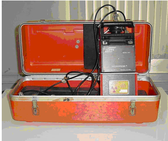
Figura 3 - Sonda de nêutrons modelo 503 Hydroprobe da CPN Corporation
