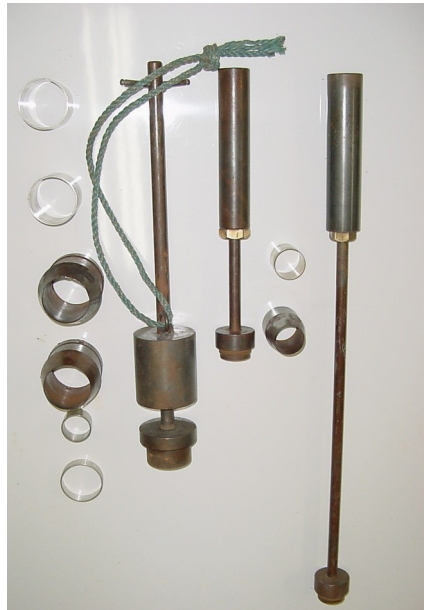
Figura 2 - Amostrador do tipo Uhland utilizado para a coleta das amostras indeformadas
